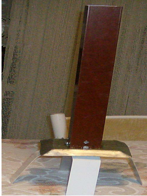
Resim 3.3 : Alüminyum eloksallı kutu profil kullanılarak hazırlanan baca
