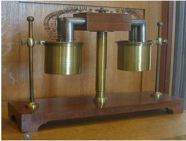
Resim 2.3: Pouillet termoelektrik jeneratörü (1840)
