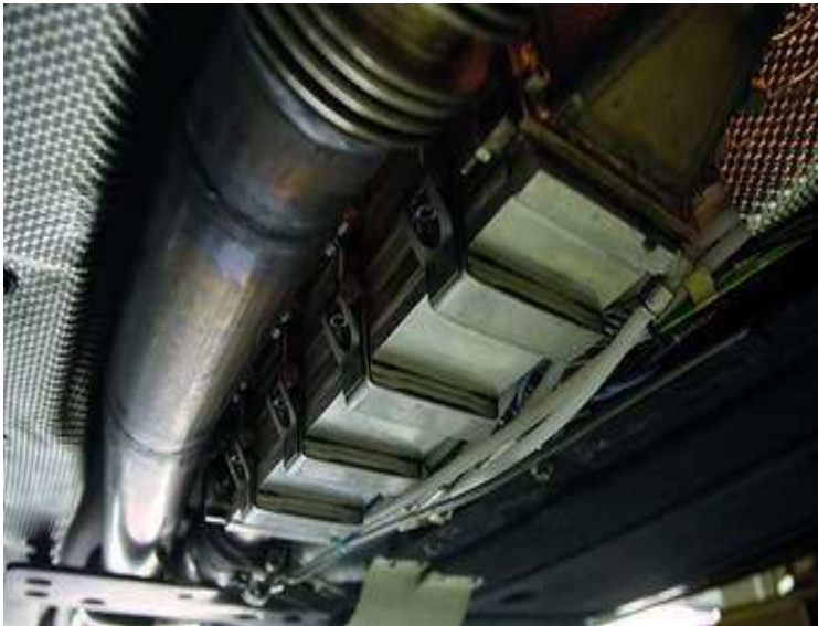
Resim 2.14 : Termoelektrik jeneratörlerin otomobil egzozunda kullanılması
