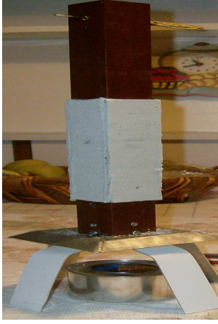
Resim 3.4: Alüminyum eloksallı kutu profil kullanılarak hazırlanan baca
