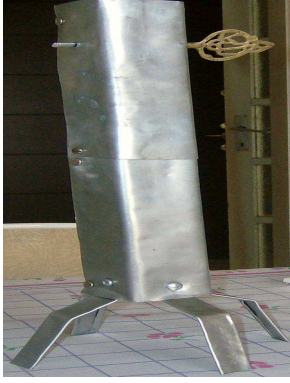
Resim 3.2: 0.5mm alüminyum levha kullanılarak hazırlanan baca
