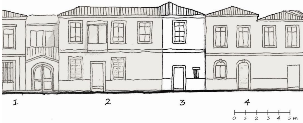
Şekil 4.24 A Bölgesi 3 No'lu Yapı Zeytin Sokak Cephesi
