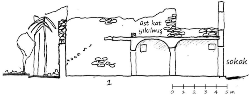
Şekil 4.148 D Bölgesi 1 No'lu Yapı b kesiti
