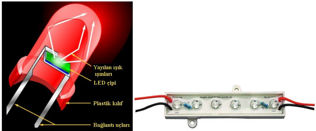
Resim 2.12. LED kesiti ve LED şerit 157
