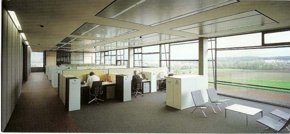
Resim 3.24. Gün ışığı, genel aydınlatma ve bölgesel aydınlatmanın bir arada kullanılması. 211
