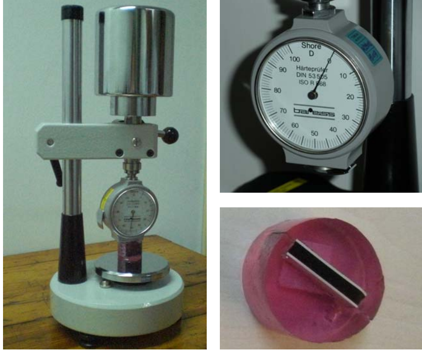
Şekil 4. 8 Bareiss marka Shoremetre ile polietilen malzemenin sertlik ölçümü (YTÜ Metalürji Fakültesi Laboratuvarı)
