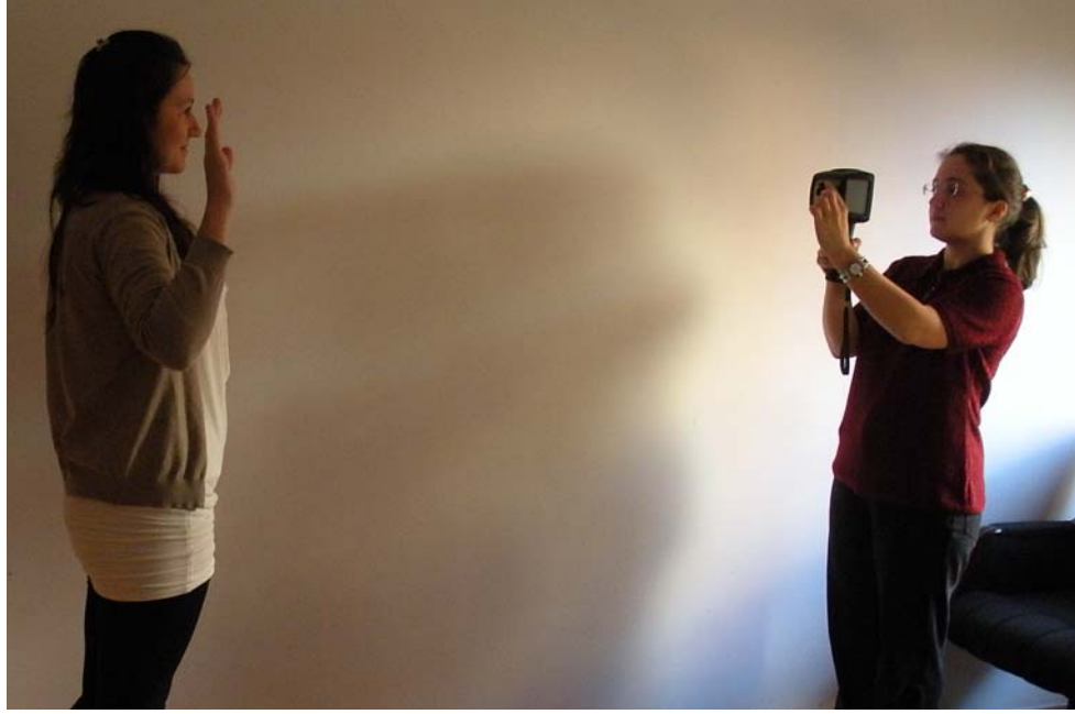
Şekil 4. 22 Deneklerin vücut ısısının termal kamera ile ölçülmesi
