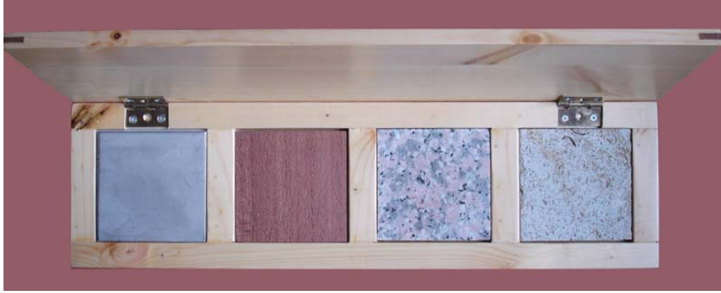
Şekil 4. 20 Malzemelerin dörtlü kombinasyonu ile oluşturulmuş deney kutuları
