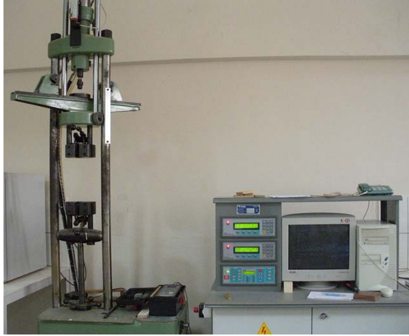
Şekil 4. 10 Janka sertlik ölçüm ekipmanı (İÜ Orman Fakültesi Laboratuvarı)
