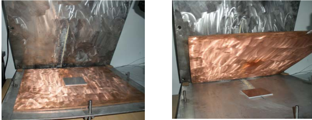
Şekil 4.18 Malzemelerin çift deney parçalı mahfazalı sıcak plâka cihazı ile sıcaklıklarının ölçümü (YTÜ Metalürji Fakültesi Laboratuvarı)
