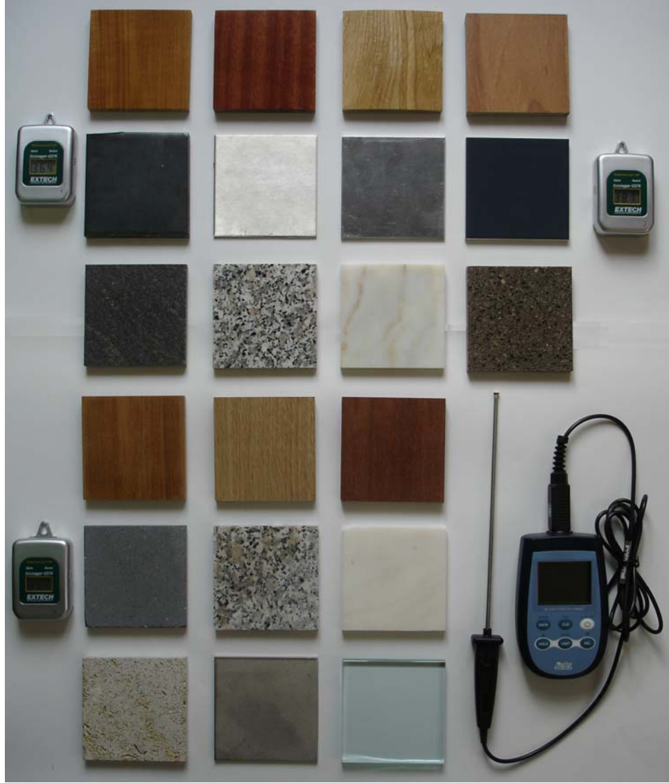
Şekil 4. 15 Örneklerin sıcaklık ölçüm düzeni
