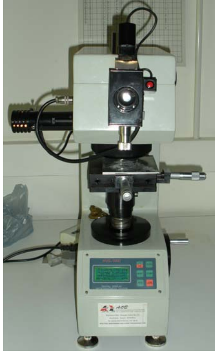
Şekil 4. 6 HVS 1000 Mikrosertlik ölçüm cihazı (YTÜ Metalürji Fakültesi Laboratuvarı)
