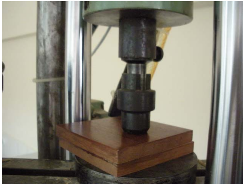
Şekil 4. 11 Ahşap malzeme örneklerinin sertlik ölçümü
