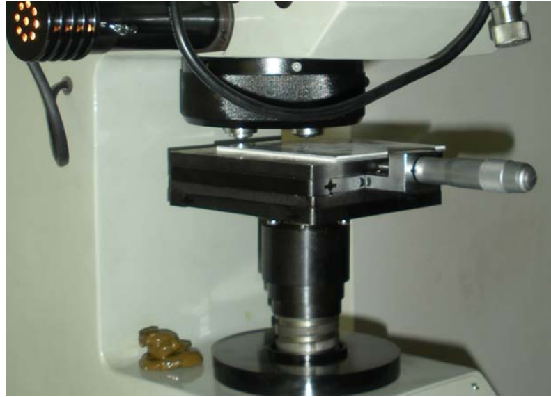
Şekil 4. 7 Metal örneklerin sertlik ölçümleri
