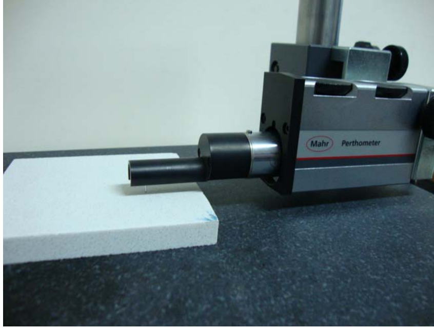
Şekil 4. 13 Malzemelerin yüzey pürüzlülük ölçümü (YTÜ Metalürji Fakültesi Laboratuvarı).
