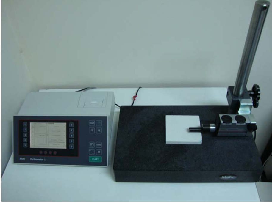
Şekil 4. 12 Mahr Perthometer S2 yüzey pürüzlülük ölçüm cihazı (YTÜ Metalürji Fakültesi Laboratuvarı)
