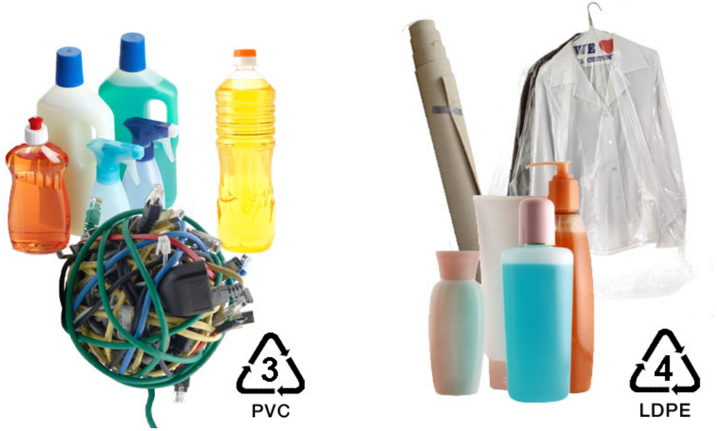
Şekil 2.7. : PVC (Polyvnyl Chloride) ve LDPE (low density polyethylene) tipi plastiklerin sembolleri ve kullanım alanları.
