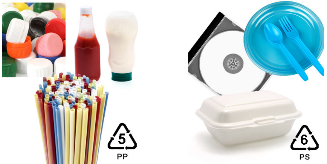
Şekil 2.8. : PP (Polypropylene) ve PS (Polystyrene) tipi plastiklerin sembolleri ve kullanım alanları.
