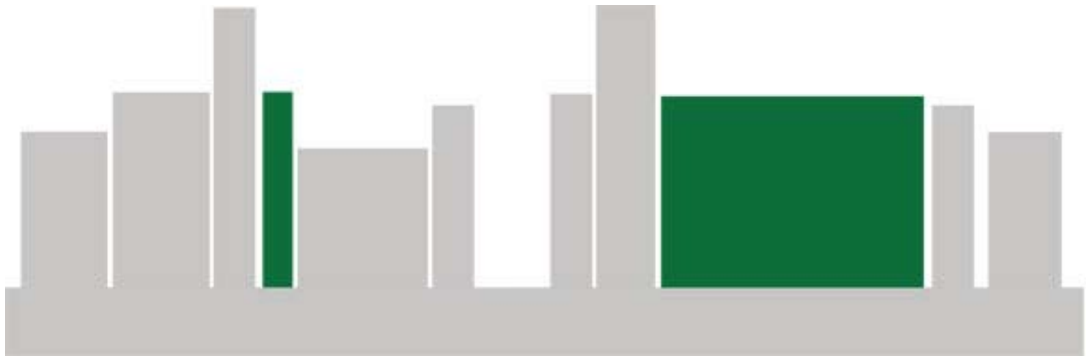
Şekil 2. 2. Yüksek yapı tanımlamasında yapının narinlik oranı önemli bir kriterdir.
