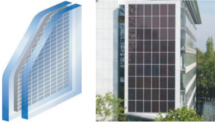
Şekil 5.47. Lamine cam şematik gösterimi ve uygulama örneği (URL-25, 2009)
