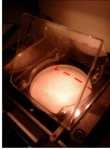
Resim 4.9. Numunenin Su Basıncına Tabi Tutulması
