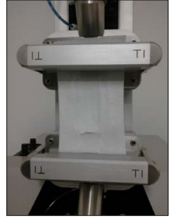
Resim 4.14. Deneyin Başlaması ile Gerilen Numune
