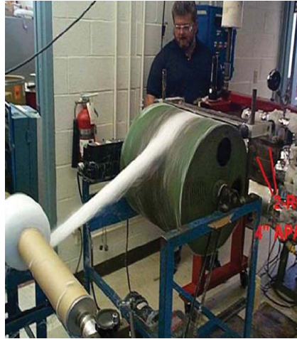
Resim 2.2. Meltblowing Yönteminde Baskı Silindirlerinden Geçen Kumaş
