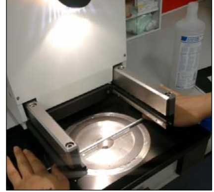
Resim 4.7. Taşan Suyu Çelik Boru Yardımıyla Temizlenmesi.
