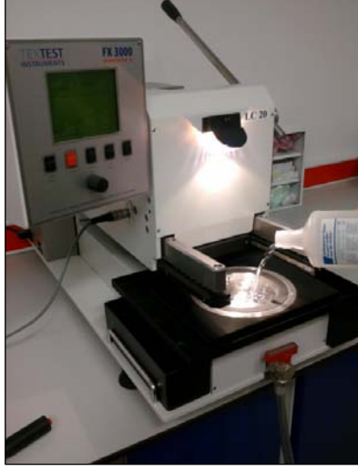
Resim 4.6. Su haznesine Su Dökülürken
