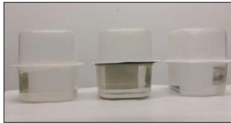
Resim 4.2. Kullanılan Malzeme Numunelerin ve Kapların Ön Görünüşü (Solda ki:Tyvek-Solid, Ortada ki Mogul-Rowa-pro Örtüsü, Sağda ki Nanolif Membran)
