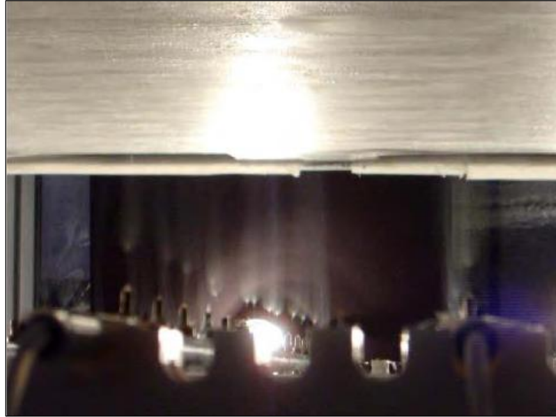
Resim 3.3 Elektro üretim İle Nanolif Membran Üretimi [5]
