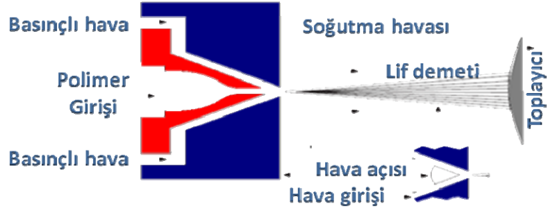
Şekil 2.11. Meltblowing Yöntemi ile Üretimin Jenerik Şeması
