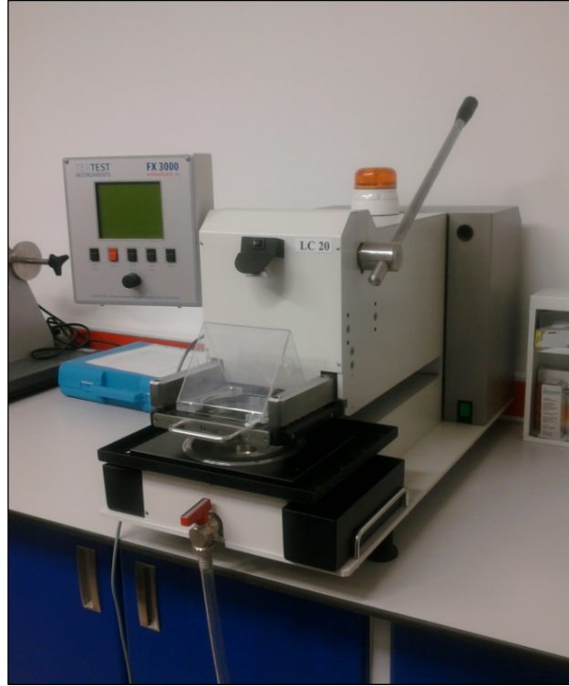
Resim 4.5. Otomatik Hidrostatik Tester Ünitesi Genel Görünüşü
