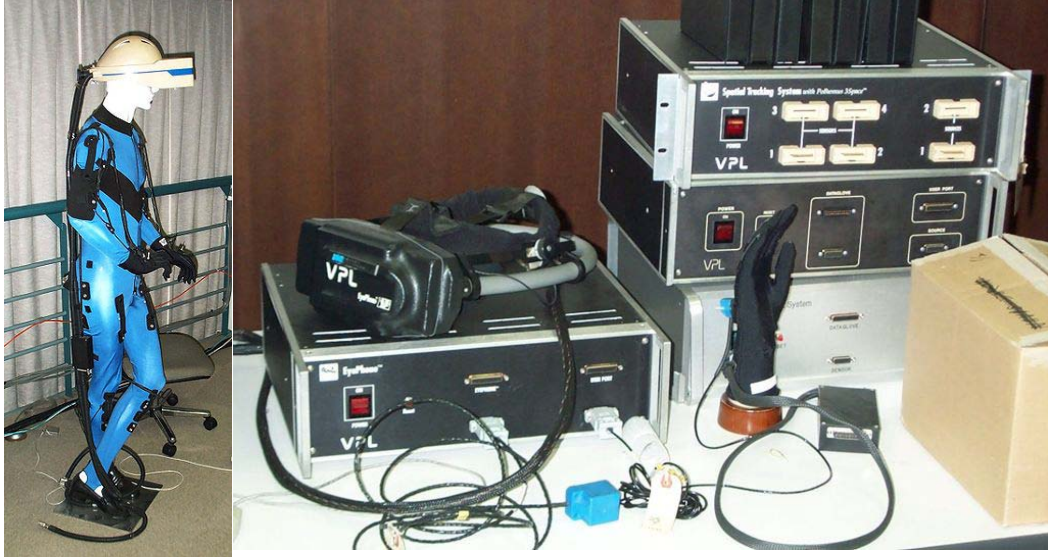
Şekil 2-10 VPL Research tarafından geliştirilen veri eldiveni ve BTS örnekleri (Wikipedia contributors, "Virtual Reality," 2010)
