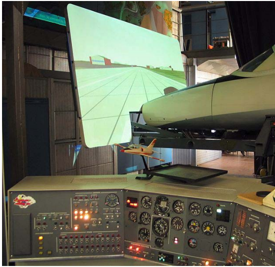
Şekil 2-12 TL39 3 eksenli hareketli uçuş simülatörü
