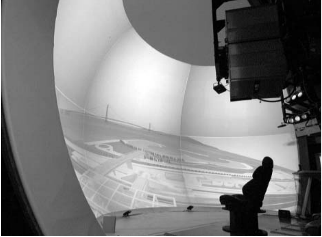
Şekil 2-2 Dalınan sistemlere bir CAVE 4 uygulaması örneği (Whyte, 2002)
