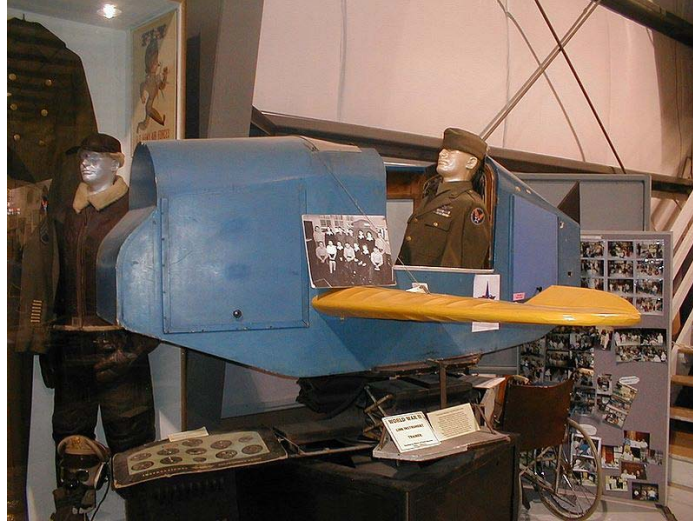
Şekil 2-4 "Link Trainer" 2. Dünya Savaşı sırasında ünlenen uçuş eğitim simülatörü (Wikipedia contributors, "Flight Simulator " 2010)
