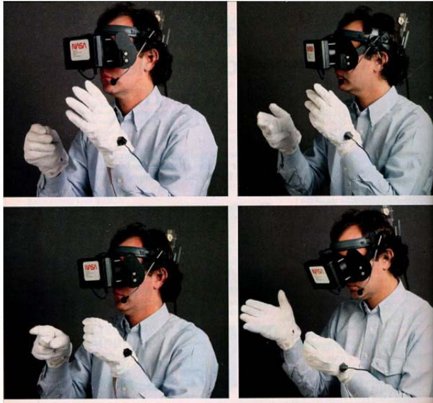
Şekil 2-9 1980'lerde NASA Ames'te tasarlanan başa takılı sunum (Brown, 2003)
