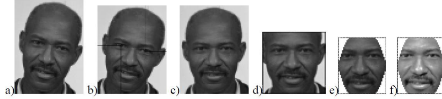
Şekil 4.3 Hinton ve Teh'in yüz tanıma için yaptıkları önfiltreleme. a) Orijinal görüntü, b)Gözlerin belirlenmesi, c) Gözlere göre çevirme işlemi, d)Kırpma işlemi, e) Arka plan temizleme, f) Yoğunluk histogramı dengeleme
