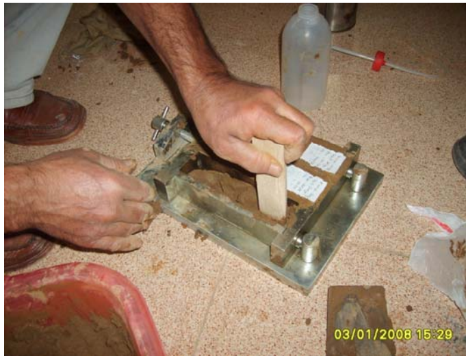
Şekil 3.31. Tuğla Hamurunun Çimento Kalıplarına Konulması
