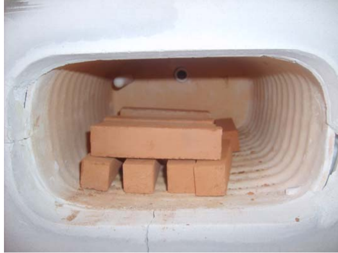
Şekil 3.36. Tuğlaların Fırında Pişirilmesi
