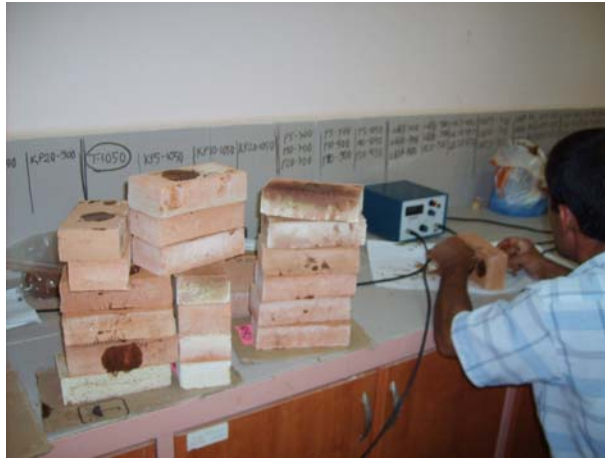
Şekil 3.43. Numunelerin Ultrasonik Ses Deneyine Tabi Tutulması
