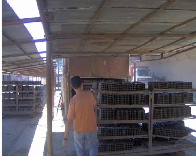
Şekil 3.18. Ön Kurutmada Bekletilen Tuğlaların İkincil Kurutma İşlemi İçin Ön Fırına Girdirilmesi İşlemi
