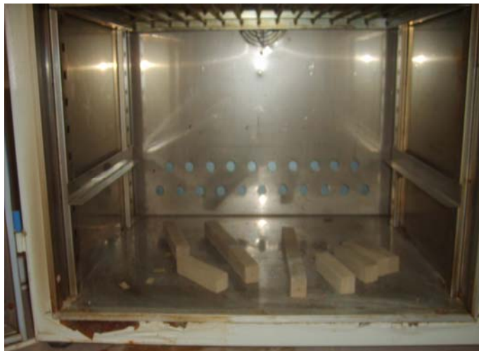
Şekil 3.35. Tuğla Numunelerin Etüvde Kurutulması
