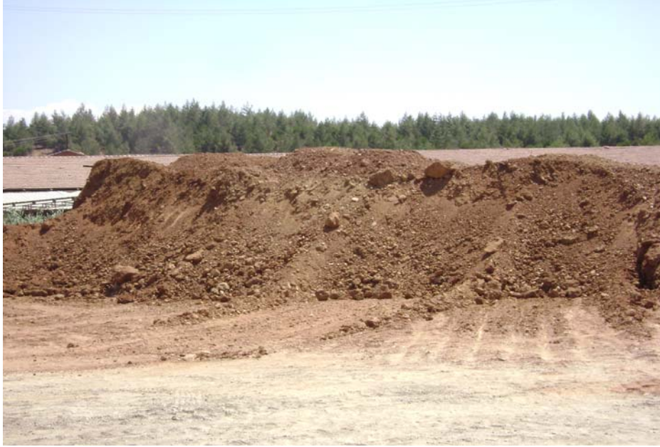
Şekil 3.1. Menzelet' ten Alınan ve İşçimenler Tuğla Üretim Fabrikasında Kullanılan Kırmızı Kil
