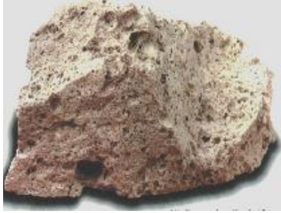
Şekil 3.6. Özgül Ağırlığı 1,0 – 2,0 gr/cm 3 Arasında Değişen Bazaltik Pomza
