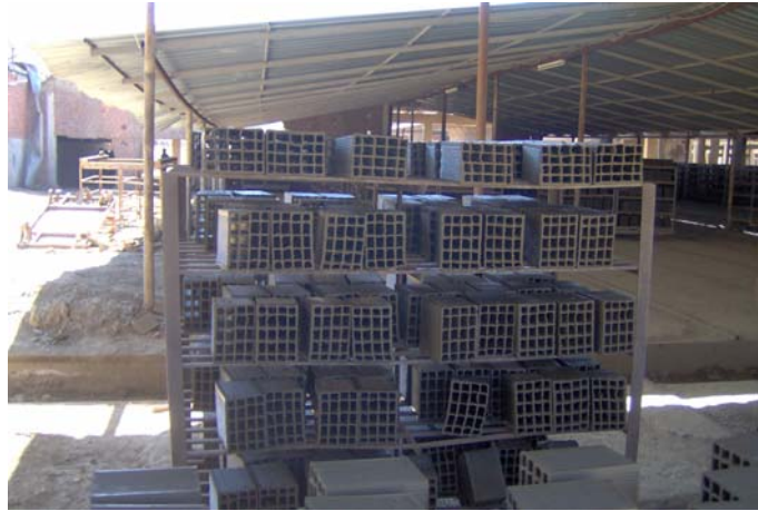
Şekil 3.16. Ön Kurutmada İstifli Bir Şekilde Bekletilen Tuğlalar
