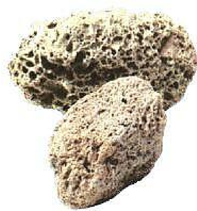
Şekil 3.5. Özgül Ağırlığı 0,5 – 1,0 gr/cm 3 Arasında Değişen Asidik Pomza
