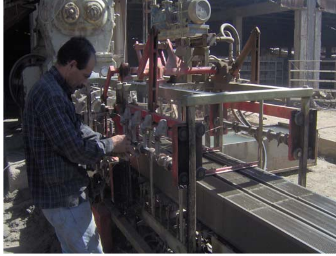
Şekil 3.13. Otomatik Sistemde Tel Yardımı ile Kesilen ve Standart Boyut Verilen Tuğlalar
