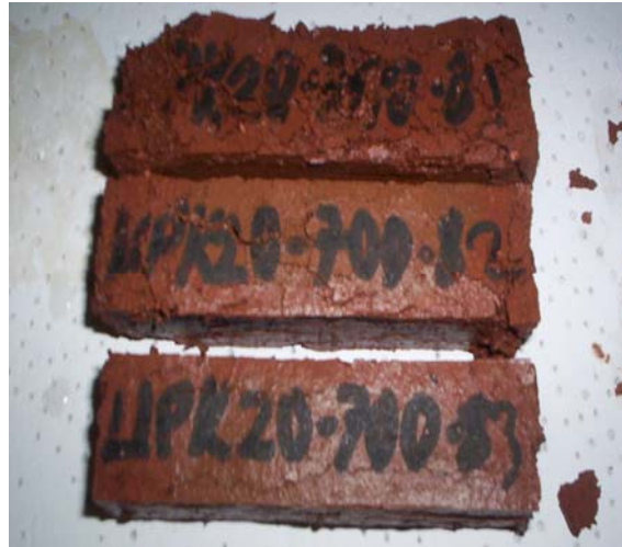
Şekil 4.13. Donma-Çözülme Çevriminde Dağılan Uçucu Kül Katkılı Numuneler
