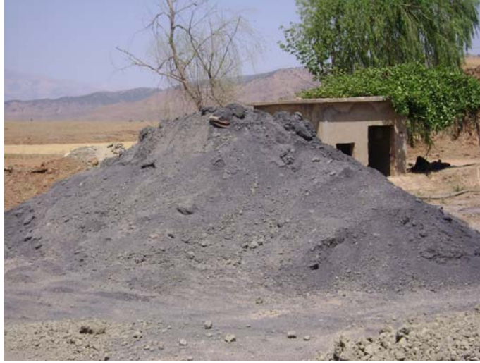
Şekil 3.4. Afşin-Elbistan Termik Santralinden Alınan ve İşçimenler Tuğla Üretim Fabrikasında Kullanılan Uçucu Kül
