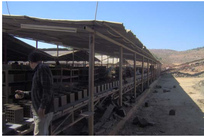
Şekil 3.14. Ön Kurutmaya Gitmeden Kusurlu Örneklerin Ayrılma İşlemi
