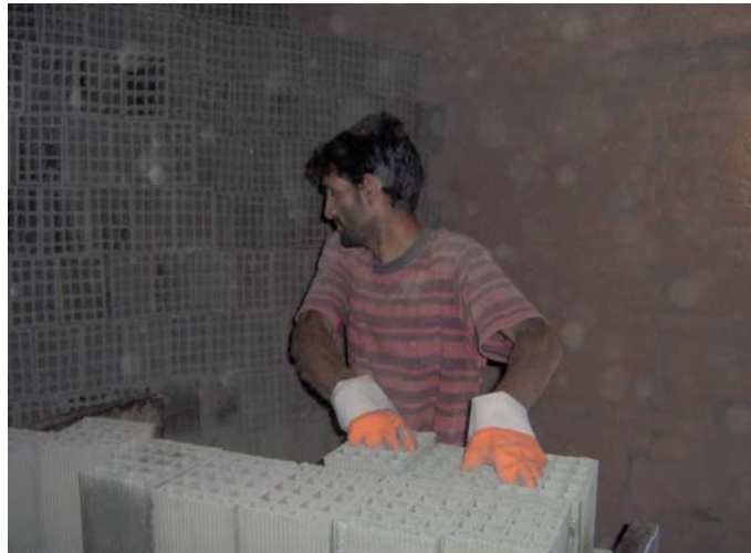
Şekil 3.20. Ana Fırında Pişirmek Üzere İstiflenen Tuğlalar
