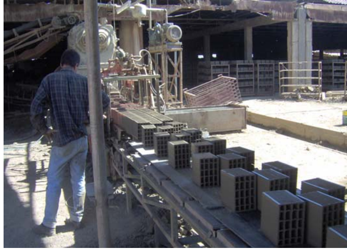
Şekil 3.15. Ön Kurutmaya Gitmeden Kusurlu Örneklerin Ayrılma İşlemi
