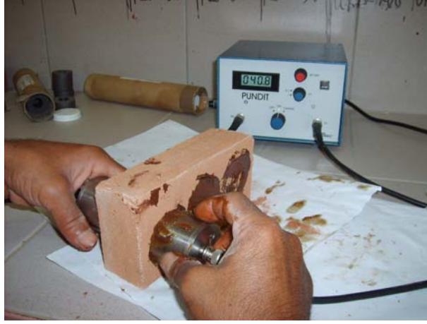
Şekil 3.42. Numunelerin Ultrasonik Ses Deneyine Tabi Tutulması
