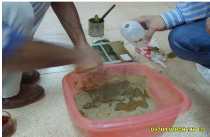
Şekil 3.29. Tuđla Hamurunun Hazırlanması
