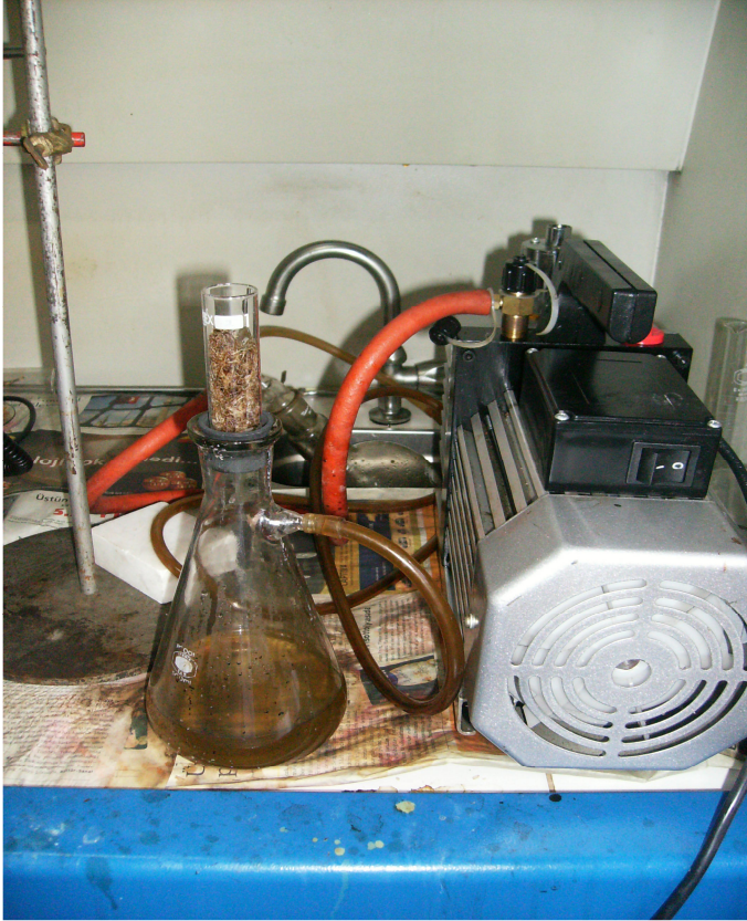
Şekil 3.12. Modifikasyon sonrası vakum altında kimyasal maddelerin liflerden uzaklaştırılması.
