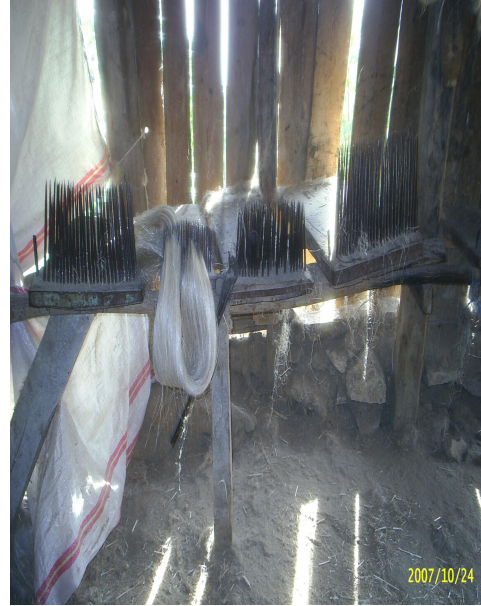
Şekil 3.3. Tarama işleminin yapıldığı tezgahlar. Şekil 3.4. Tarama işlemi tamamlanmış lifler.
