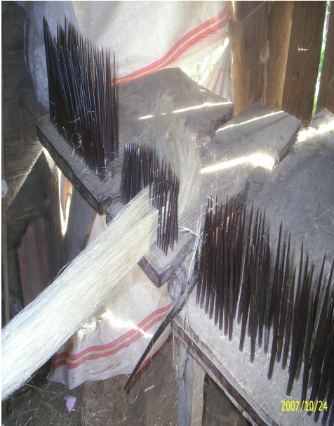
Şekil 3.3. Tarama işleminin yapıldığı tezgahlar. Şekil 3.4. Tarama işlemi tamamlanmış lifler.
