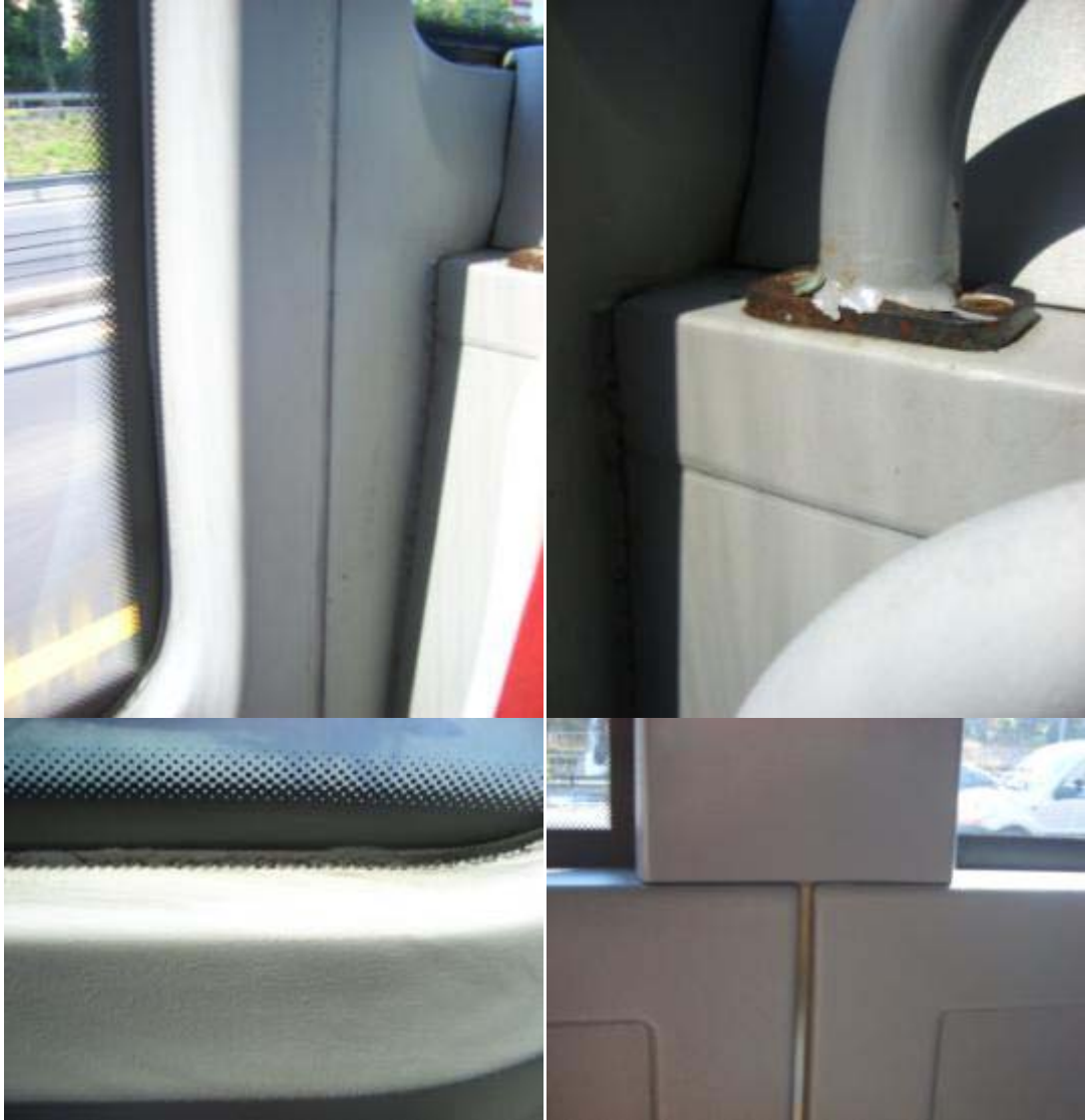
Şekil 4.60 Phileas ve Capacity pencere birleşim detayları, Temmuz 2010
