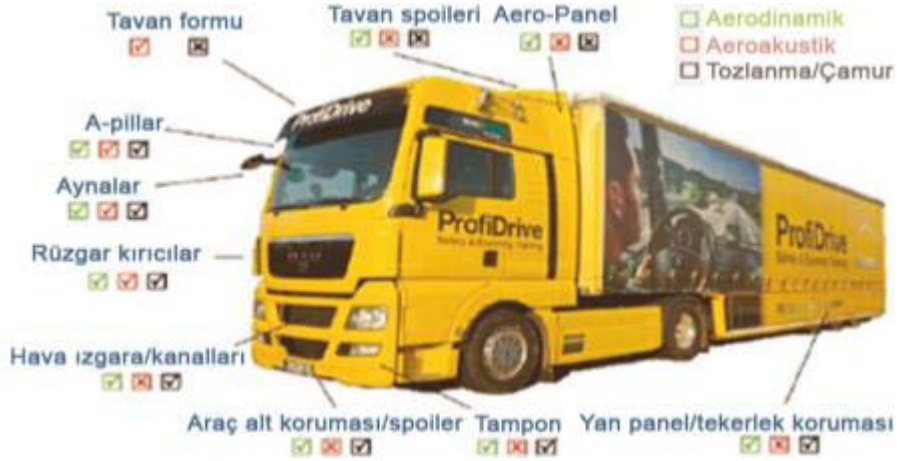
Şekil 4.17 Tır dış tasarımında aerodinamik/aeroakustik/çamurlanma birimleri [339]
