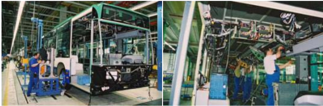
Şekil 4.36 Mannheim fabrikasında Citaro şase üretimi 2003 [292]
