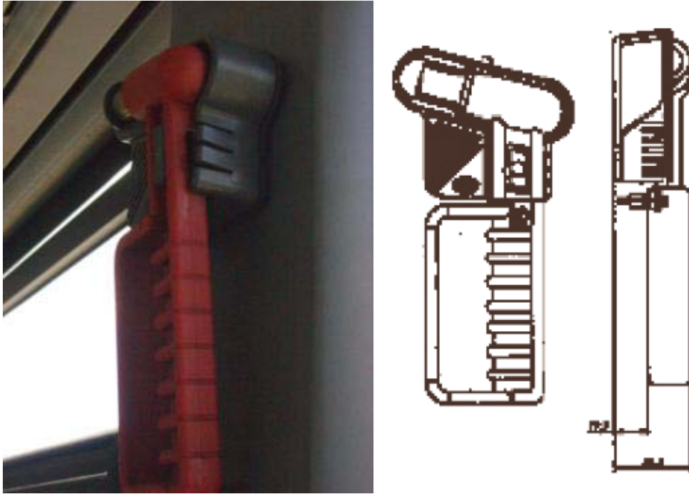
Şekil 4.61 GHE emniyet çekici teknik resmi ve Capacity yerleşimi Ağst 2010
