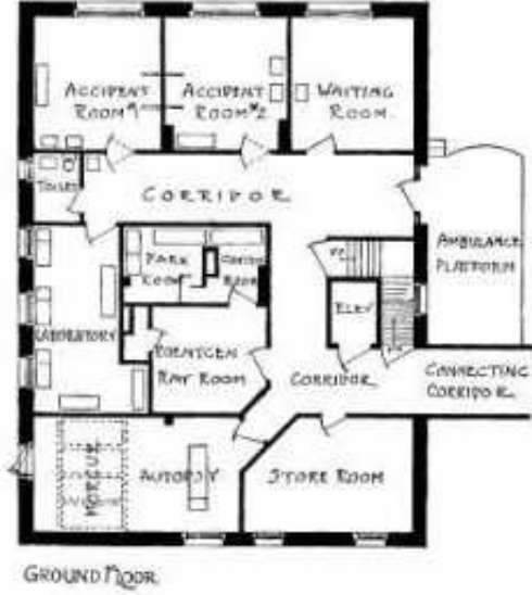
Şekil 3.3: Amerika'da Acil servis içinde acil odaya yakın olarak konumlandırılmış ilk radyoloji bölümü planı. 73
