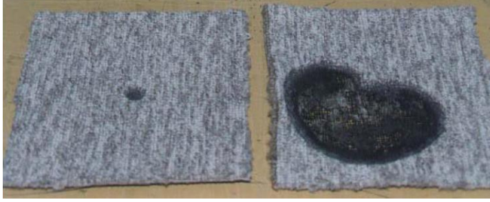
Şekil 3.58. Halıdan alınan iki numune için; soldaki çevre sıcaklığında tablet deneyini geçmiş, sağdaki numune ise kalmıştır ( http://www.awta.com.au/en/ProductTesting ).
