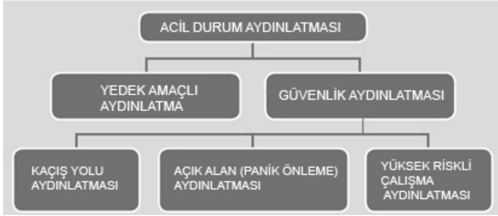
Şekil 3.38. Acil durum aydınlatmasının sınıflandırılması (BS 5266, 2005)
