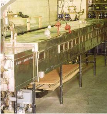
Şekil 3.55. Steiner tunnel (tünel) test cihazı ve kesiti (Hirschler, 2004)
