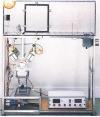
Şekil 3.61. Toksiklik deneyi ölçüm cihazı ( http://fire-testing.com/html/instruments/nibs.htm )
