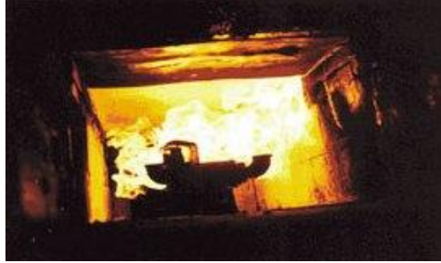
Şekil 3.55. Steiner tunnel (tünel) test cihazı ve kesiti (Hirschler, 2004)
