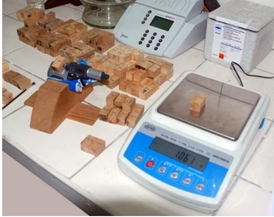
Resim 4. 45 Yoğunluk belirlenmesinde kullanılan denekler ve ölçüm sistemi (Fotograf: Dışkaya)
