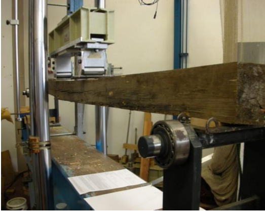
Resim 4.27 Gerçek boyutta kiriş ile yapılan statik eğilme dayanımı testi
