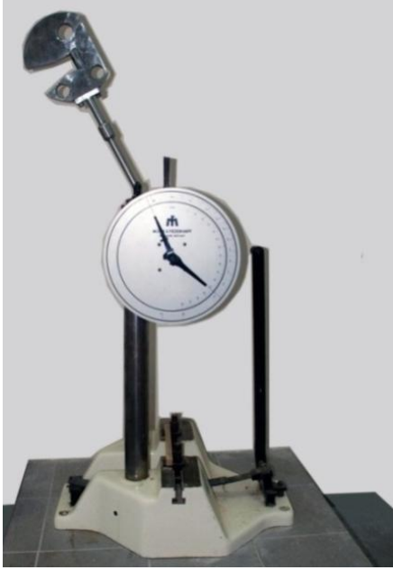
Resim 4.41 Dinamik eğilme (şok) direnci ölçüm cihazı
