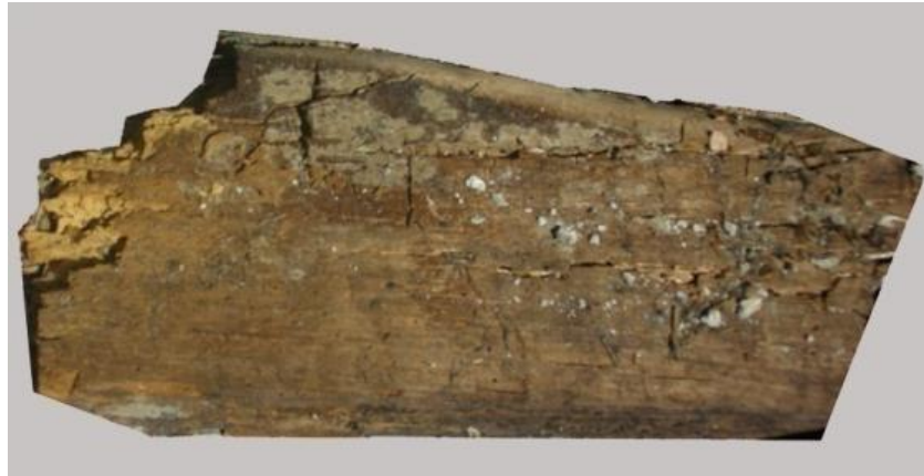
Resim A.3 Toprak altında nem etkisi ile kahverengi çürük oluşmuş kiriş parçası (Fotograf: Dışkaya)
