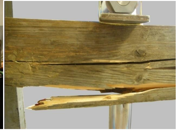
Resim 4.28 Kirişin en zayıf noktasındaki kırılma durumu (Fotograf: Dışkaya) (Fotograf: Dışkaya)
