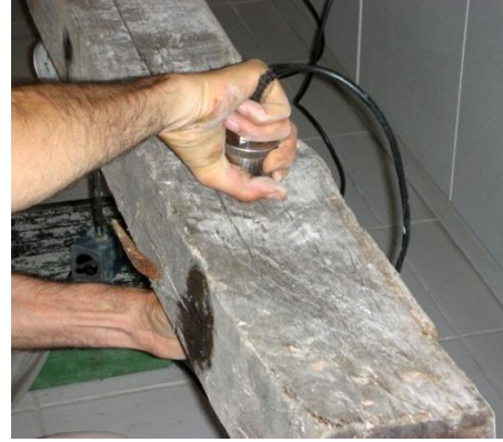
Resim 4. 24 Ultrases cihazı ile enine doğrultuda ölçüm (Fotograf: Dışkaya)
