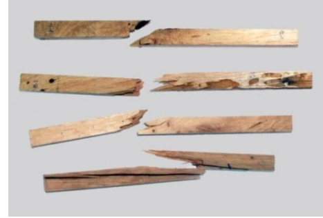
Resim 4.42 Meşe örneklerin a) kırılmadan önceki ve b) kırıldıktan sonraki durumları(Fotograf: Dışkaya)
