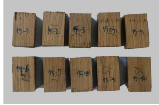
Resim 4.34 Basınç testi için boyutlandırılmış Meşe ağacından denekler
