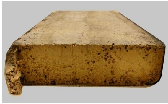
Resim B.4 İğne yapraklı ağaç taşıyıcı kesitinde larva tünelleri (Fotograf: Dışkaya)
