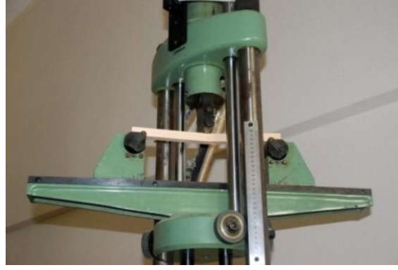
Resim 4.33 Üniversal deney cihazında elastisite modülü belirleme deneyine ait bir görünüş (Fotoğraf: Dışkaya)
