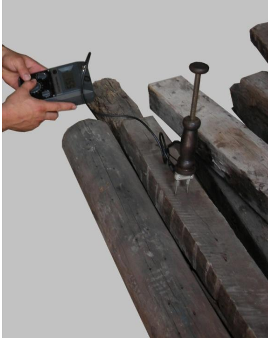
Resim 4.1 Örneklere rutubet ölçümü (Fotograf: Dışkaya)
