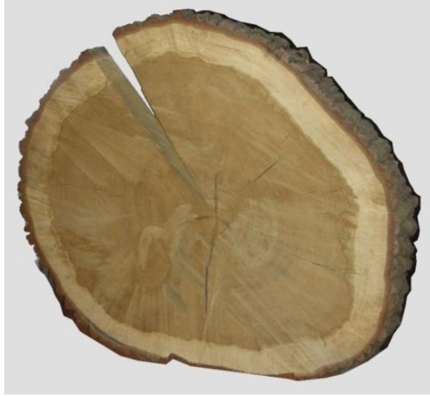
Resim 4.2 Ağaçta kurutmaya bağlı V şeklinde radyal çatlak (Fotograf: Dışkaya)
