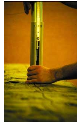
Resim 4. 21 Pilodin cihazı ile ölçüm (Uzielli ve Bonamini, 2006)
