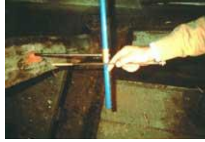
Resim 4.19 Karotin yöntemi ile örnek alınması (Uzielli ve Bonamini, 2006)
