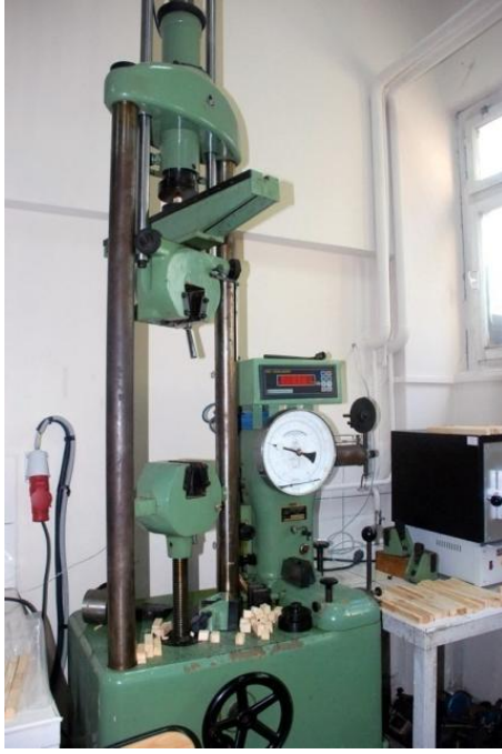
Resim 4.35 Ünlversal test cihazında basınç deneyi (Fotograf: Dışkaya)
