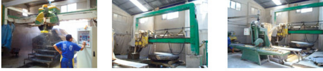
Şekil 2.9. Bazaltın fabrikada su kullanılarak elmas uçlu makinelerle kesim işlemi [33].
