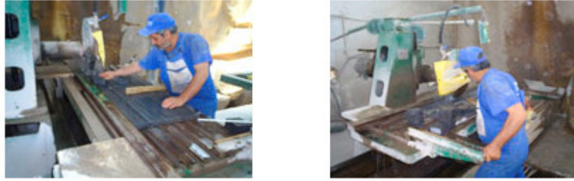
Şekil 2.10. Bazaltın fabrikada kullanıma uygun boyutlarda kesim işlemi [33].
