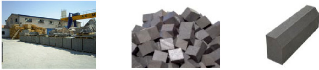
Şekil 2.11. Fabrikada istenilen boyutta kesilen bazalt [33].
