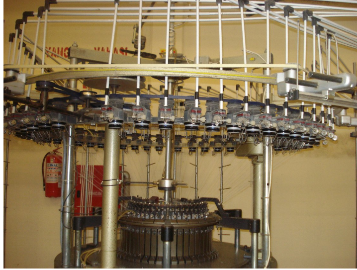
Şekil 3.2. tek furnisör sıralık yuvarlak örgü makinesi
