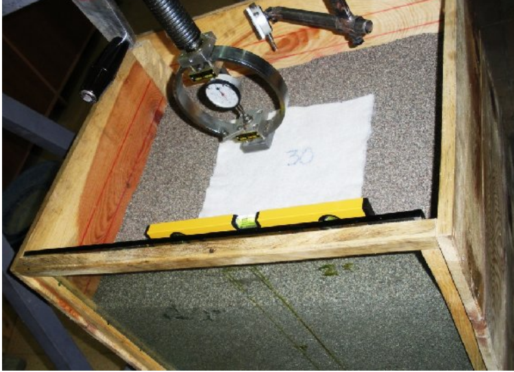
Şekil 3.9. Geotekstilin Kum Üzerine Yerleştirilmesi
