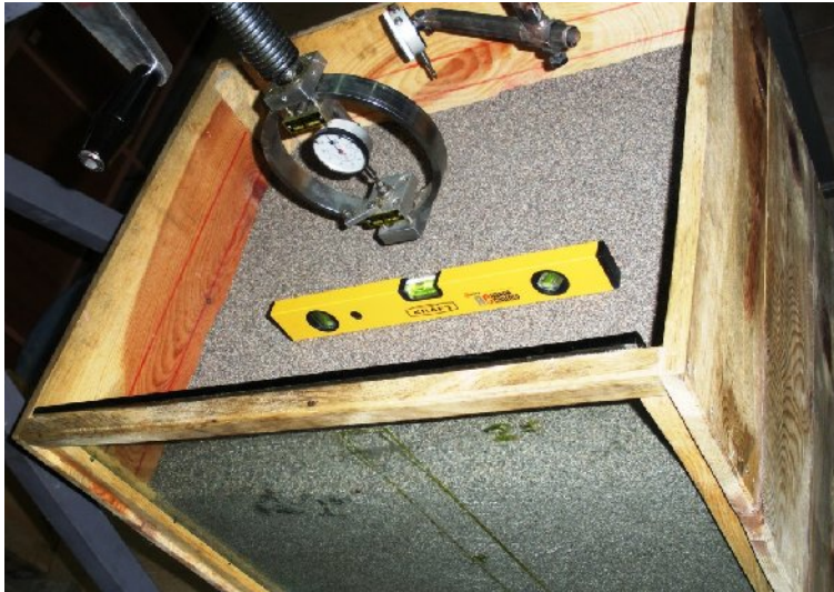
Şekil 3.8. Kum Numunelerin Kasaya Yerleştirilmesi
