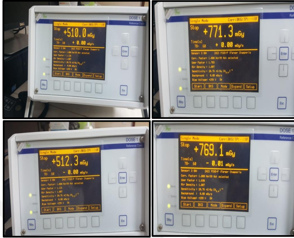
Şekil 4.26 18MV dose1 elektrometre ölçüm değerleri
