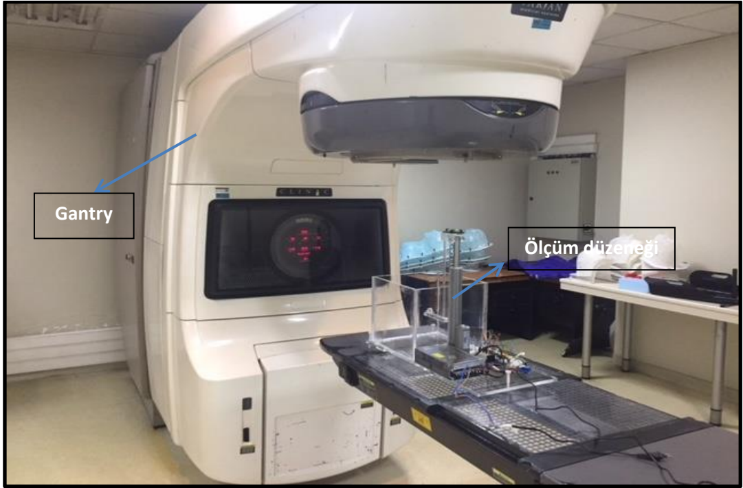
Şekil 4.17 Oluşturulan sistemin Gantry "0" derece olacak şekilde yerleşimi
