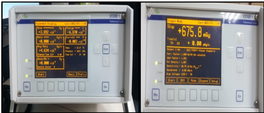
Şekil 4.25 6MV dose1 elektrometre ölçüm değerleri
