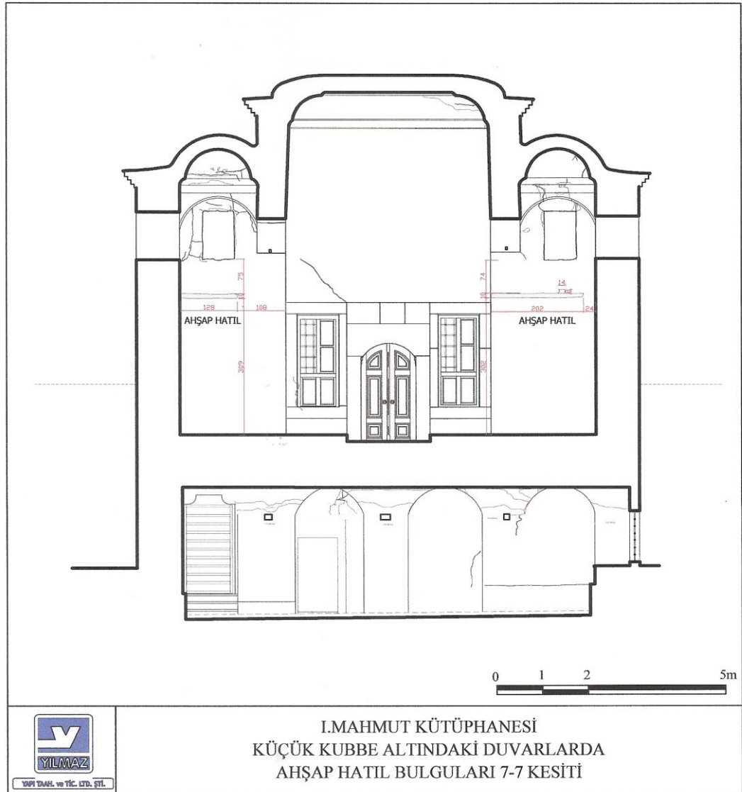
Şekil 3.15. Köşe kubbeleri altında çıkan çürümüş ahşap hatılların boyutları
