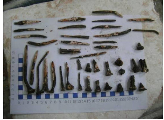
Resim 3.139. Çıkarılan paslanmış çiviler
