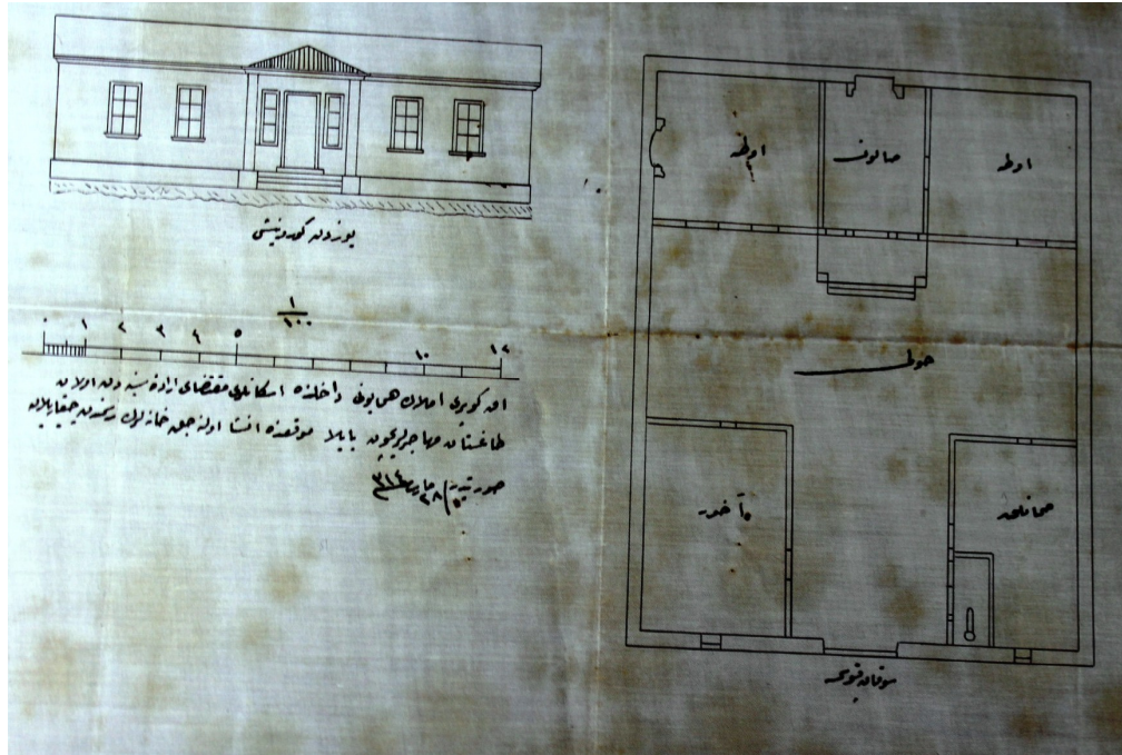
Şekil 2.29. Akköprü'de Dağıstan muhacirleri için yaptırılan evlerin plan ve ön cephe görünüşü (BOA. HH.THR. 470 /12)
