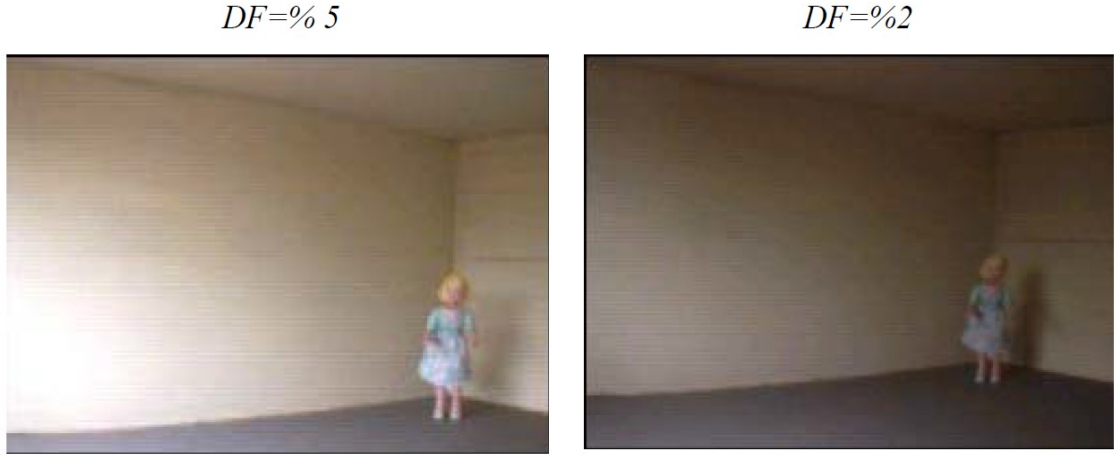
Şekil 4.29 Farklı gün ışığı faktörü miktarlarının aynı oda şartlarında bilgisayar modellemesi ile gösterilmesi (Okutan, 2008).
