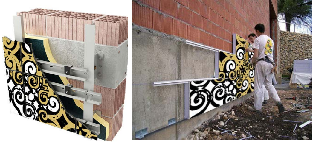
Şekil 4.56 Konstrüksiyon sistemiyle tespit edilen porselen seramik kaplamalar (URL-42)
