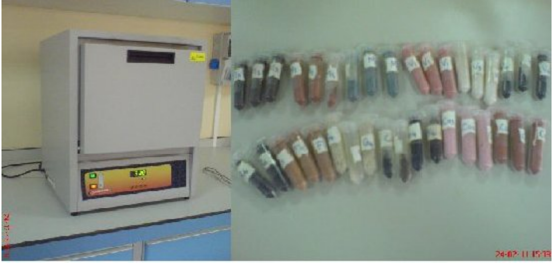
Şekil 3. 2. Kurutma fırını ve numune saklama kapları içerisinde analiz için hazır hale getirilmiş numuneler
