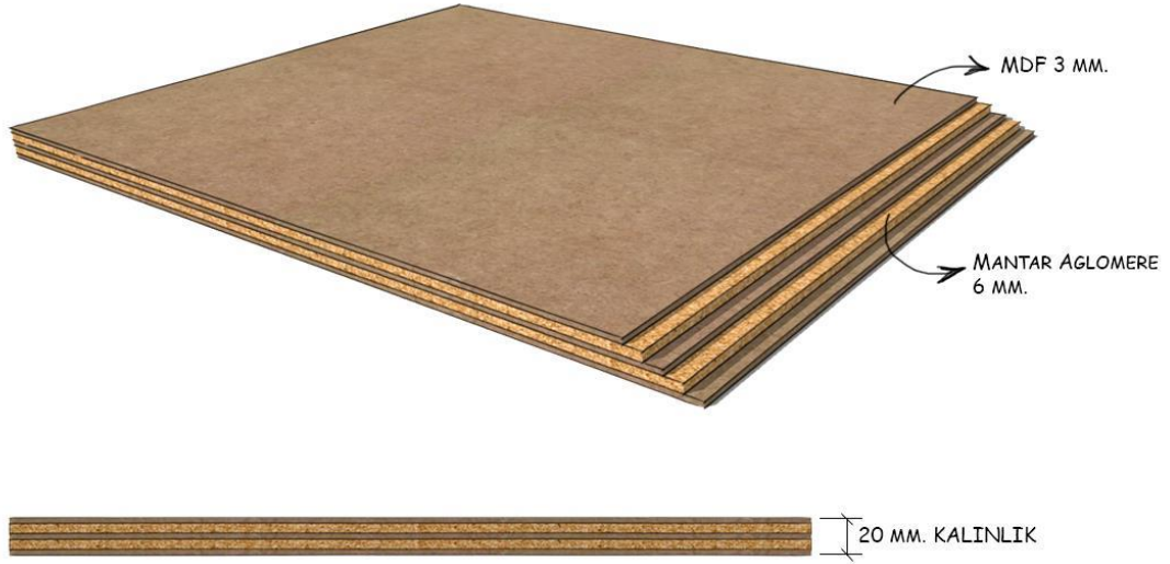
Şekil 3.1. Orta Yoğunluklu Lif Levha ve Mantar Aglomere Tabakalarıyla Oluşturulmuş Kompozit Levha Kompozisyonu
