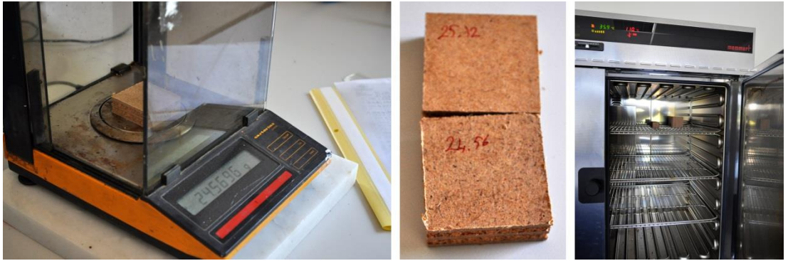
Şekil 3.8. Hassas terazide ölçüm işlemleri ve kurutma fırını
