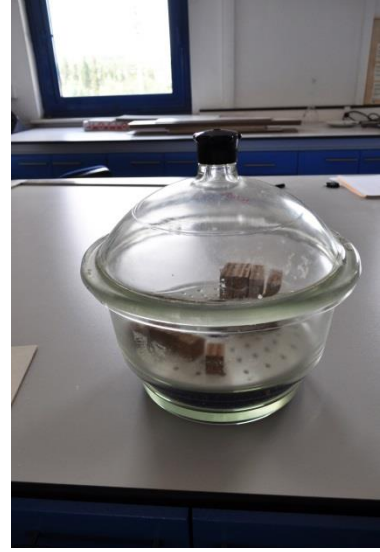
Şekil 3.13. Desikatörde soğutulan numuneler
