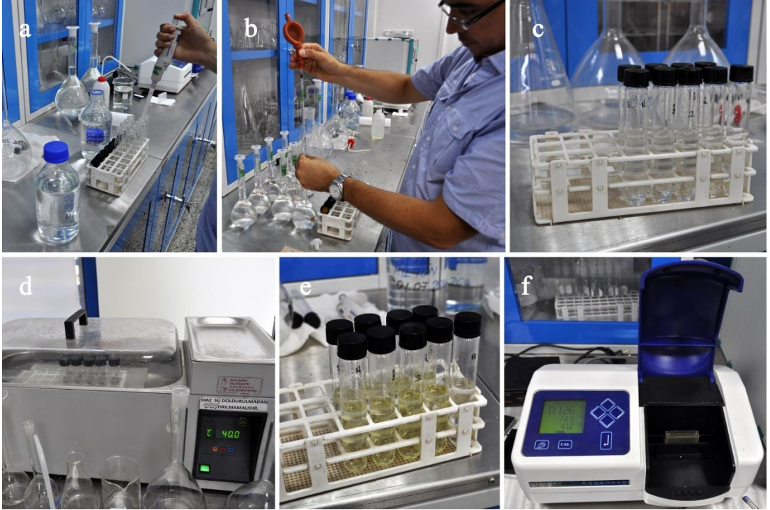
Şekil 3.23. Erlene pipet yardımıyla amonyum asetat ve asetil aseton çözeltisi ilave edilmesi (a). Erlene cam jodelerden sulu çözelti nakli (b). Isıtıcı su banyosuna yerleştirilmek üzere hazırlanmış 9 adet erlen (c). Isıtıcı su banyosu cihazı (d). 40°C lik suda 15 dakika boyunca bekletildikten sonra oluşan yeşilimsi sarı renkte çözelti (e). Spektrofotometre cihazı ve içine yerleştirilmiş absorbanstayini yapılacak çözelti (f).
