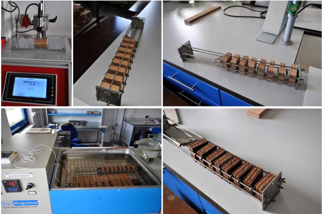
Şekil 3.14. Komparatörle kalınlık tespiti yapılmış numunelerin suya daldırma öncesi ve daldırma sonrası görüntüleri
