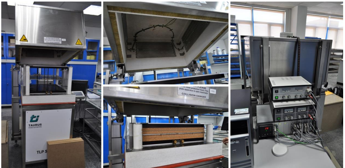
Şekil 3.19. Korumalı tablalı ısıl iletkenlik ölçüm cihazı ve deney düzeneği
