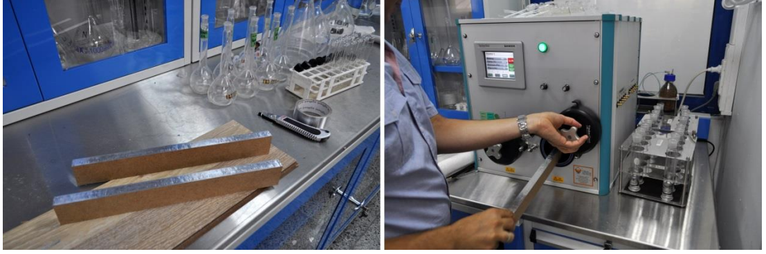
Şekil 3.9. Folyo bant ile yalıtılmış numunelerin gaz analiz cihazına yerleştirilmesi
