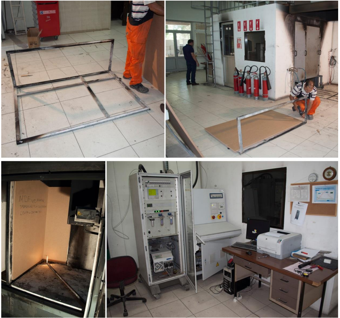
Şekil 3.10. TSE İzmir EX Lab. Yangına mukavemet deney düzeneği ve test cihazları
