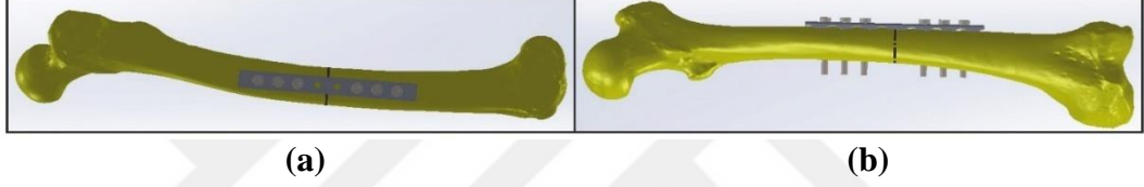
Şekil 3.16. P15-Komb2'nin üç boyutlu modelleri. (a) Üst görünüş, (b) Yan görünüş.
