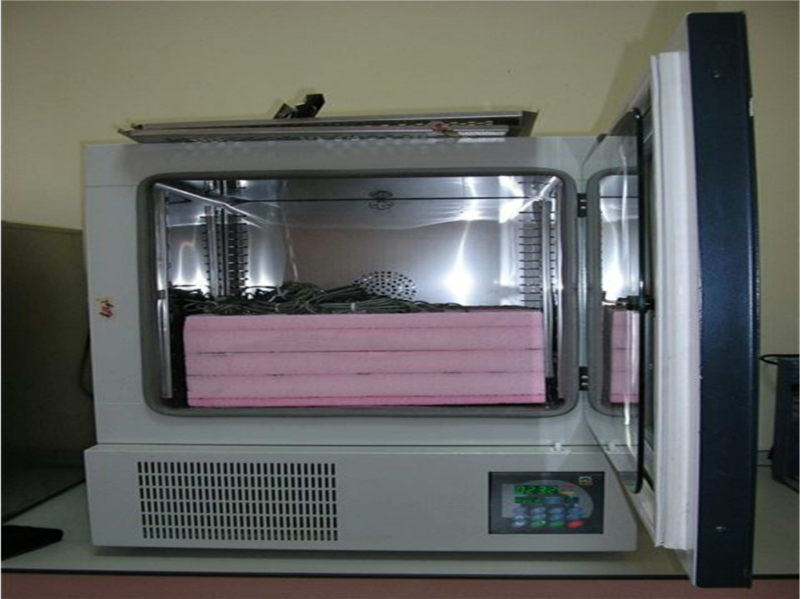
Şekil 3.3. Aerobik stabilite düzeneğinin sabit sıcaklıktaki (25 °C) inkübatöre yerleştirilmesi
