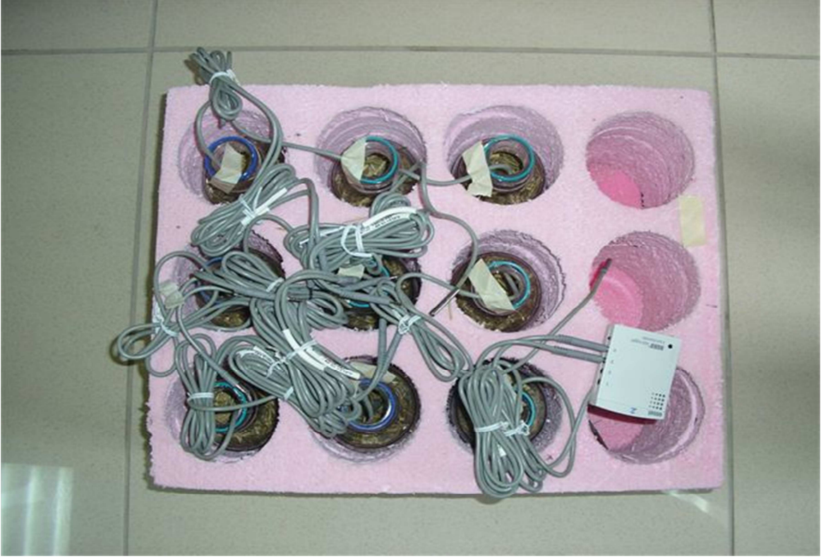
Şekil 3.2. Silajların cam şişelere konarak aerobik stabilite düzeneğine yerleştirilmesi
