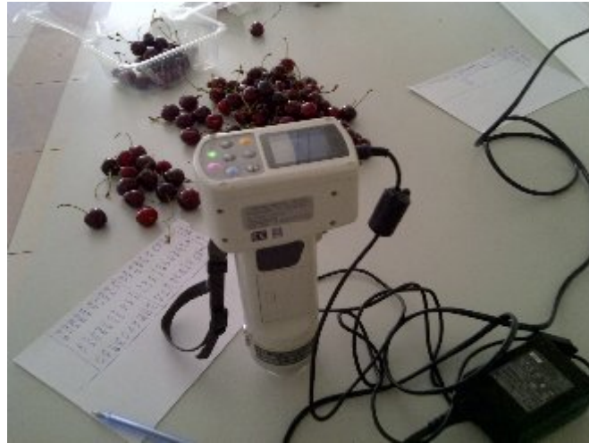
řekil 3.2.6. Meyve renginin CR-400 Kromometre ile ölçülmesi.
