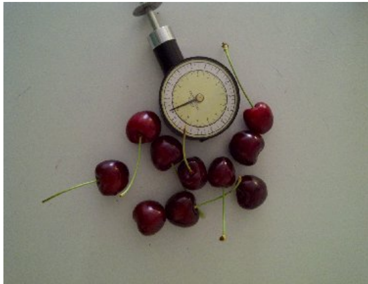
Şekil 3.2.5. Meyve sertliğinin penetrometre ile ölçülmesi.
