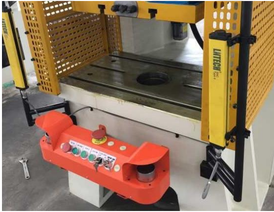
Resim 2.33: Güvenli çalıştırma modülü olan pres makinesi. (URL- 23)
