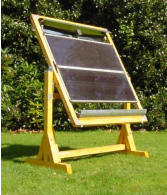
Şekil 3.11 Bimetalik şerit kullanılarak üretilen pasif güneş takipçisi prototipi (Clifford ve Eastwood, 2004).
