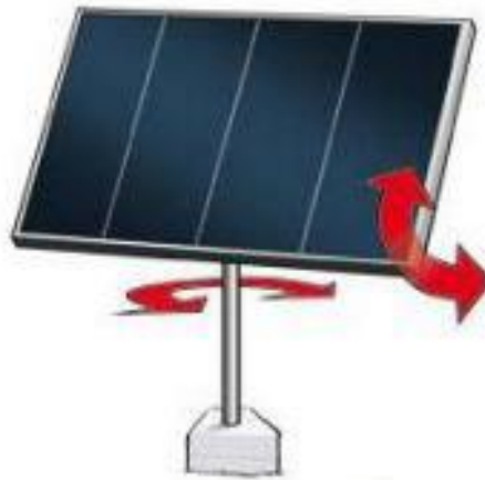
Şekil 3.8 İki eksenli güneş izleme sistemi (Anameriç, 2014).
