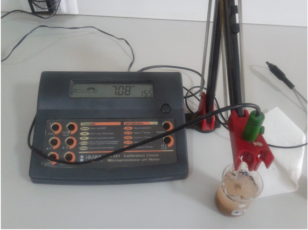
Şekil 3.4. pH metre ile toprak reaksiyon analizi
