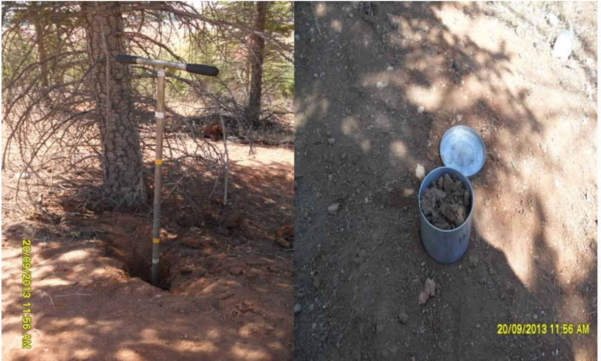
Şekil 3.2. Toprak burgu aleti ile numune alımı ve saklama kabı
