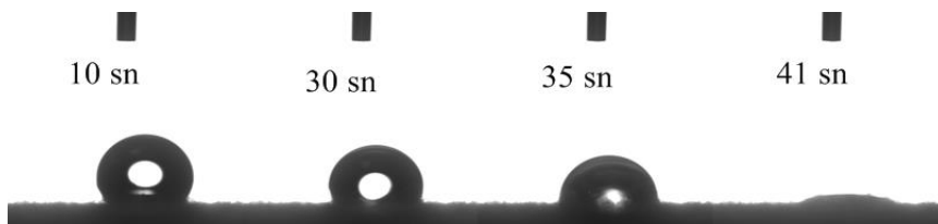
Şekil 6.63 G_HM3 Kodlu emülsiyonun temas açısı görüntüsü
