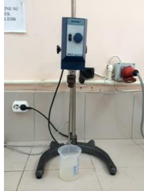
Şekil 5.3. Silikon Emülsiyonu Üretiminde Kullanılan Mekanik Karıştırıcı
