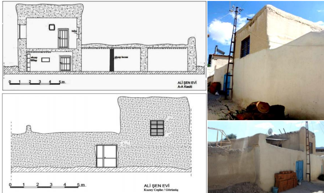
Şekil 134. Malatya, Darende'de karma sistem ile yapılmış konut (Bahçeci & Aytaç, 2017)
