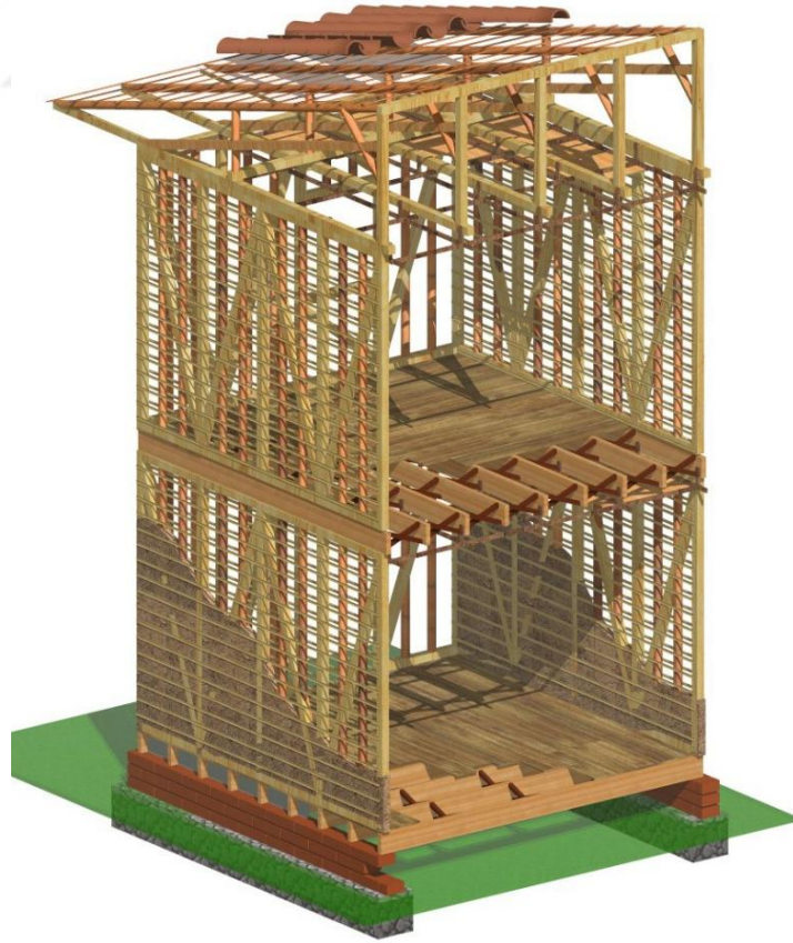
Şekil 46. Kerpiç dolgulu toprak bahareque (ahşap + bambu strüktür) (Muñoz, 2002)
