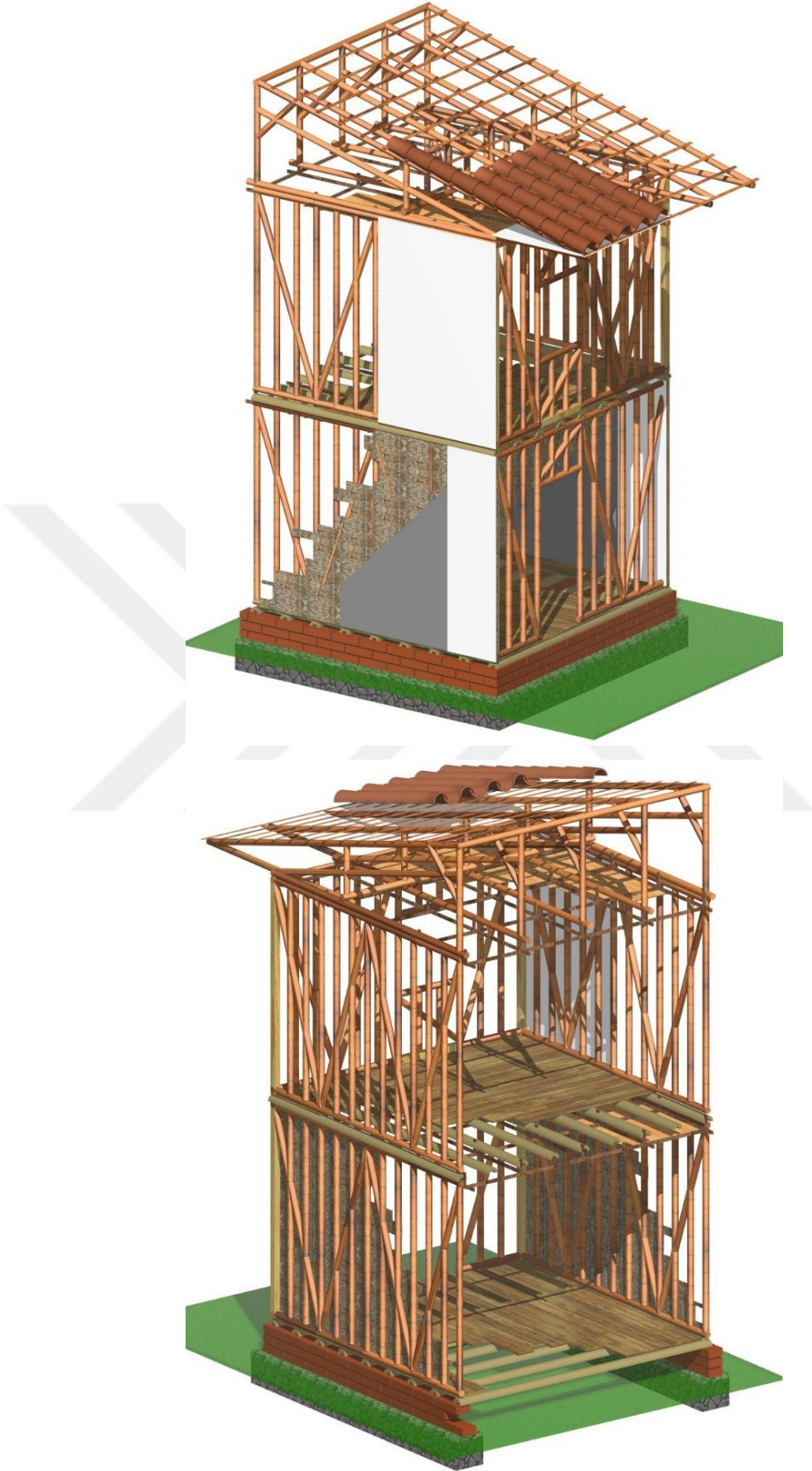
Şekil 51. Kerpiç dolgusuz toprak bahareque (bambu strüktür) (Muñoz, 2002)
