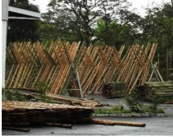
Resim 3. Bambunun doğal ve dikey olarak kurutulması (Kaminski, 2016)
