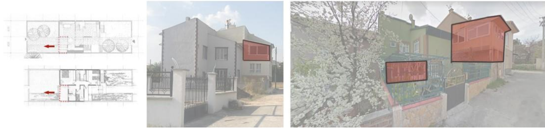
Şekil 4.154 Çorum Binevler Konut Sitesi, T Tipi Konut Biriminde Yatay ve Düşey Büyüyebilirlik Yaklaşımları-1
