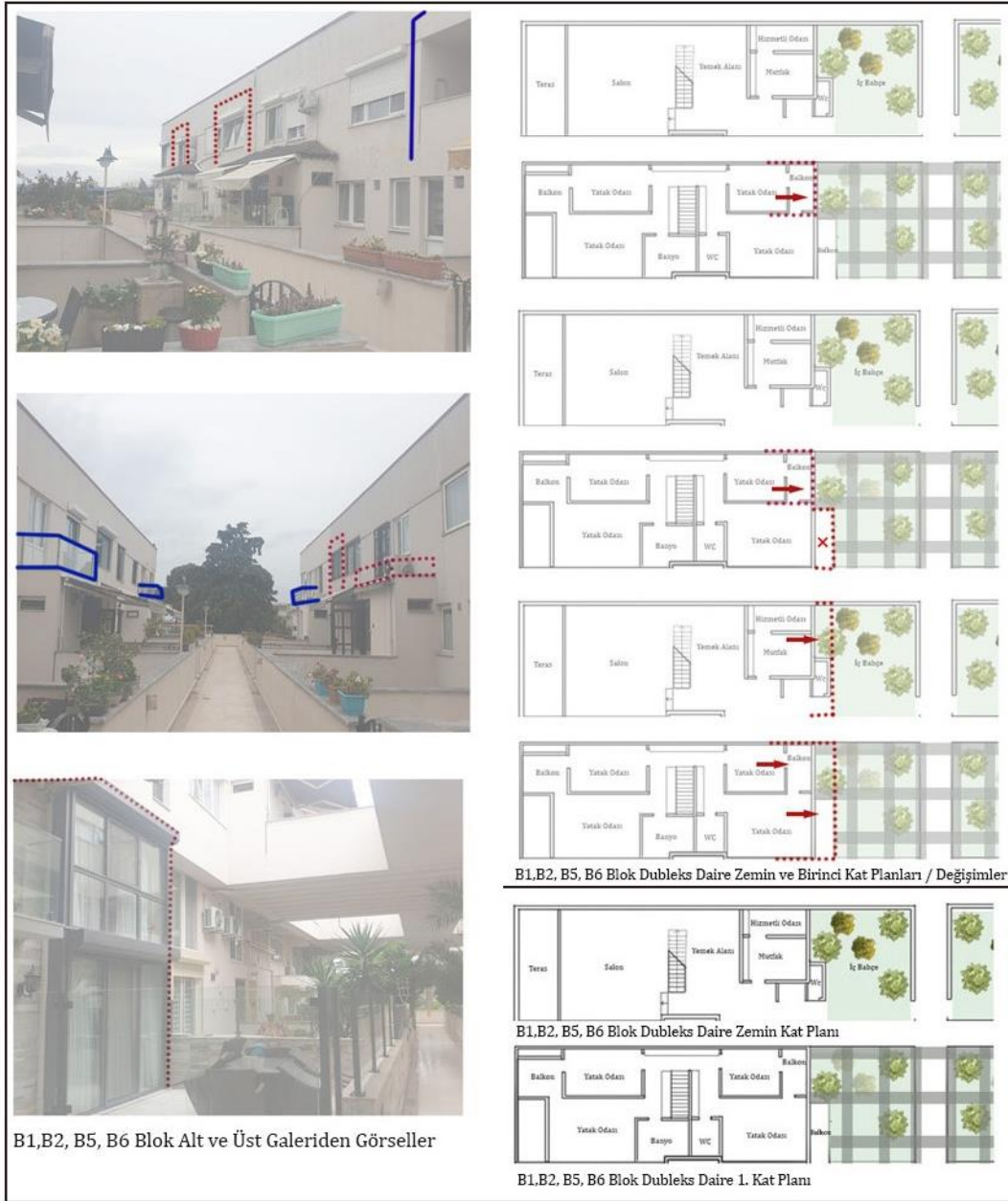
Şekil 4.99 Yeşilköy Toplu Konut Sitesi, B1,B2, B5 ve B6 Blok İç Cephede Balkonun Konut Birimine Dâhil Edilmesi
