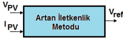
Şekil 3-29. Artan iletkenlik metodu blok diyagramını
