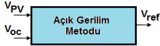
Şekil 3-26. Açık gerilim metodu blok diyagramını
