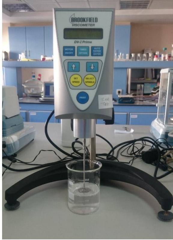
Şekil 3.6. Brookfield viskozimetresi ile MC'nin viskozitesinin belirlenmesi
