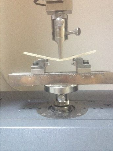
Şekil 3.7 Zwick/Roell Z010 Universal Test Makinesi Eğilme Testi
