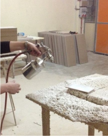
Şekil 3.16 Poliüretan Yüzeyine Tutkal Uygulanması
