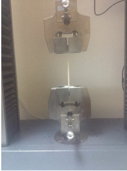
Şekil 3.8 Zwick/Roell Z010 Universal Test Makinesi Çekme Testi
