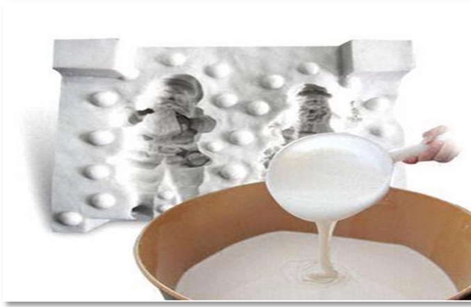
Şekil 1.10 Silikon Kalıba Poliüretan Döküm İşlemi (URL 8)
