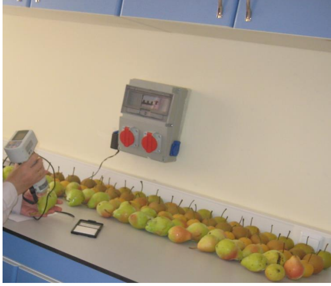
Şekil 3.8. Kromometre ile meyve kabuk renginin ölçülmesi.
