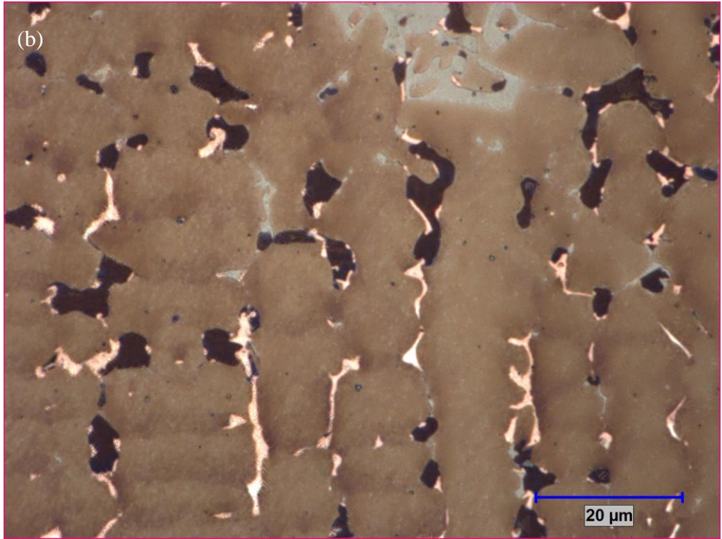
Şekil 4.14. NK ile üretilen \text{Cu}_{50}\text{Zr}_{40}\text{Ni}_5\text{Mg}_5 alaşımının OM fotoğrafları a) Dağlama öncesi; b) Dağlama sonrası
