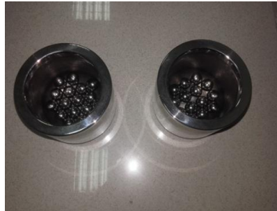
Şekil 3.4. Öğütme hazneleri ve öğütücü bilyeler
