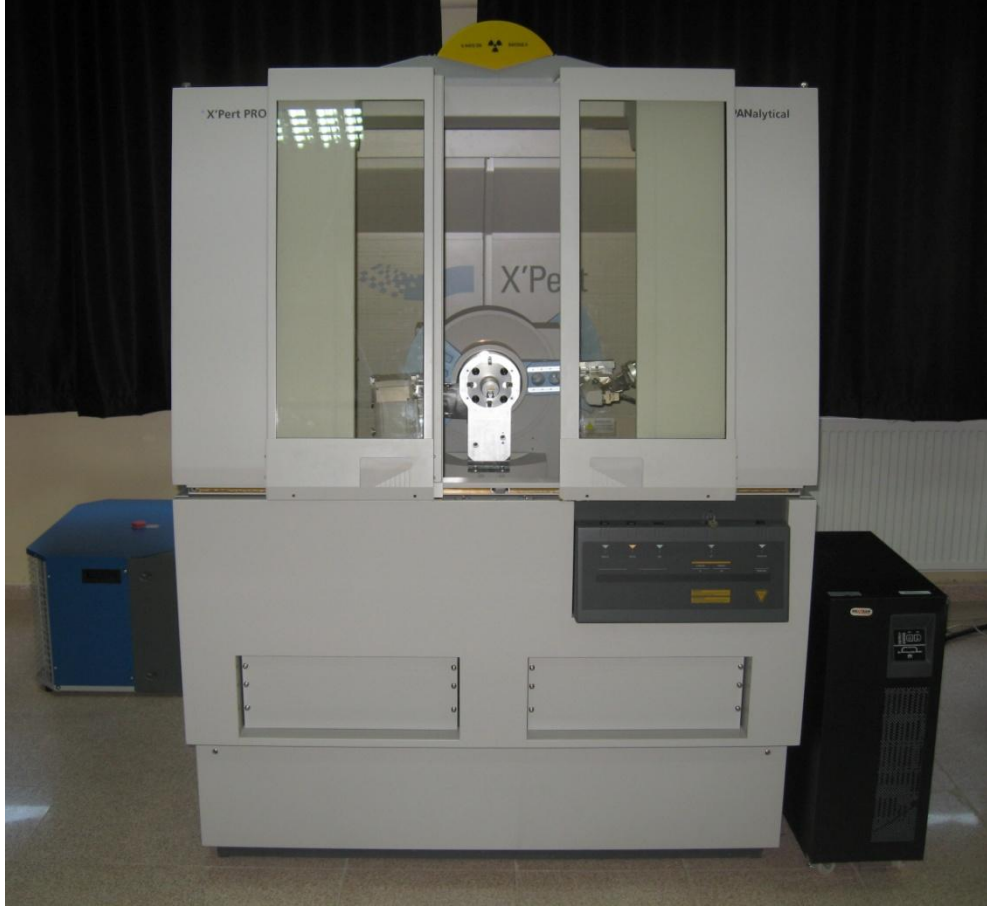
Şekil 3.15. Philips X'Pert PRO marka XRD cihazı.
