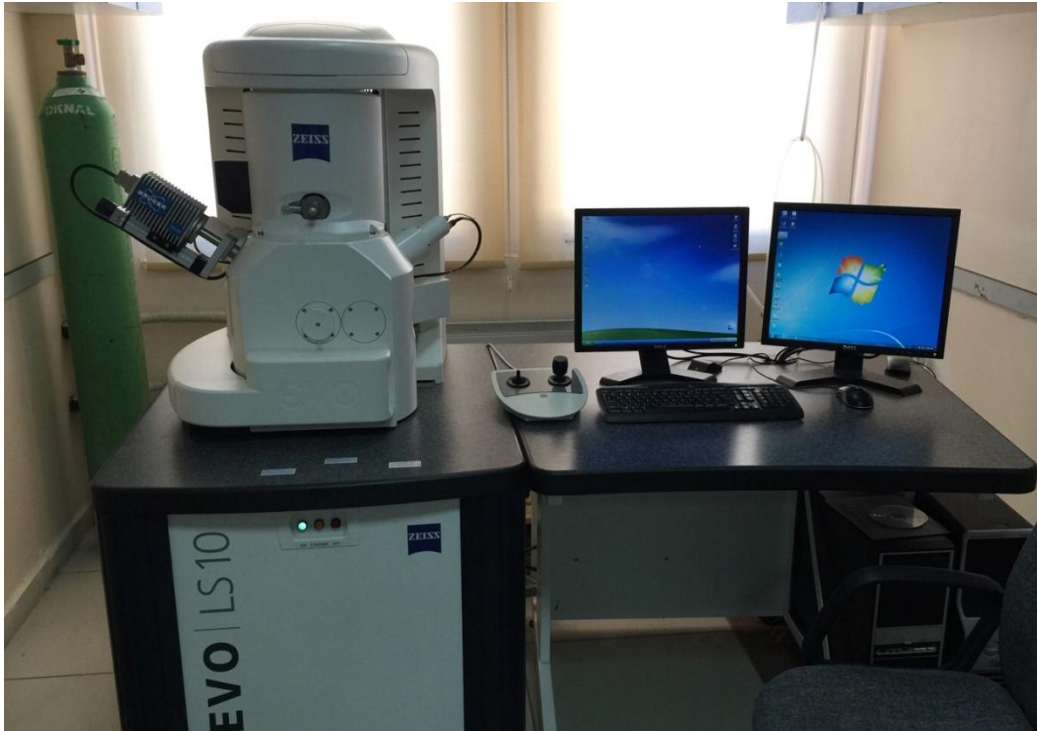
Şekil 3.17. ZEISS EVO LS10 cihazı (SEM)
