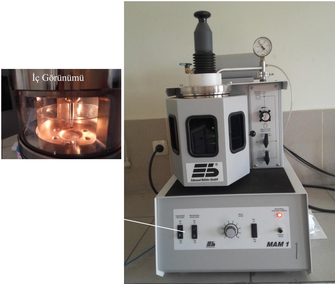
Şekil 3.6. Alaşımları normal katılaştırma ile üretmek için kullanılan ark eritme fırını (KSÜ)
