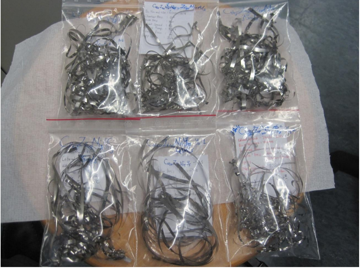
Şekil 3.12. Hızlı katılaştırma ile üretilen Cu_{50}Zr_{40}Ni_5M_5 (M=Al, Y, Ti, Mg) şerit alaşımları.
