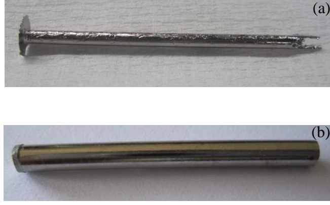
Şekil 3.14 Emme döküm ile üretilen çubuk alaşımlar (a) \text{Cu}_{50}\text{Zr}_{40}\text{Ni}_5\text{Ti}_5 ; (b) \text{Cu}_{50}\text{Zr}_{40}\text{Ni}_5\text{Si}_5
