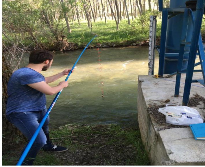
Şekil 3.8. Terbüzek deresi üzerinde en kesit ölçümü
