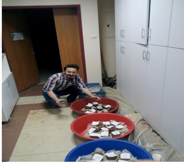
Şekil 3.11. Hacim ağırlığı toprak örneklerinin suyla doymun hale getirilmesi
