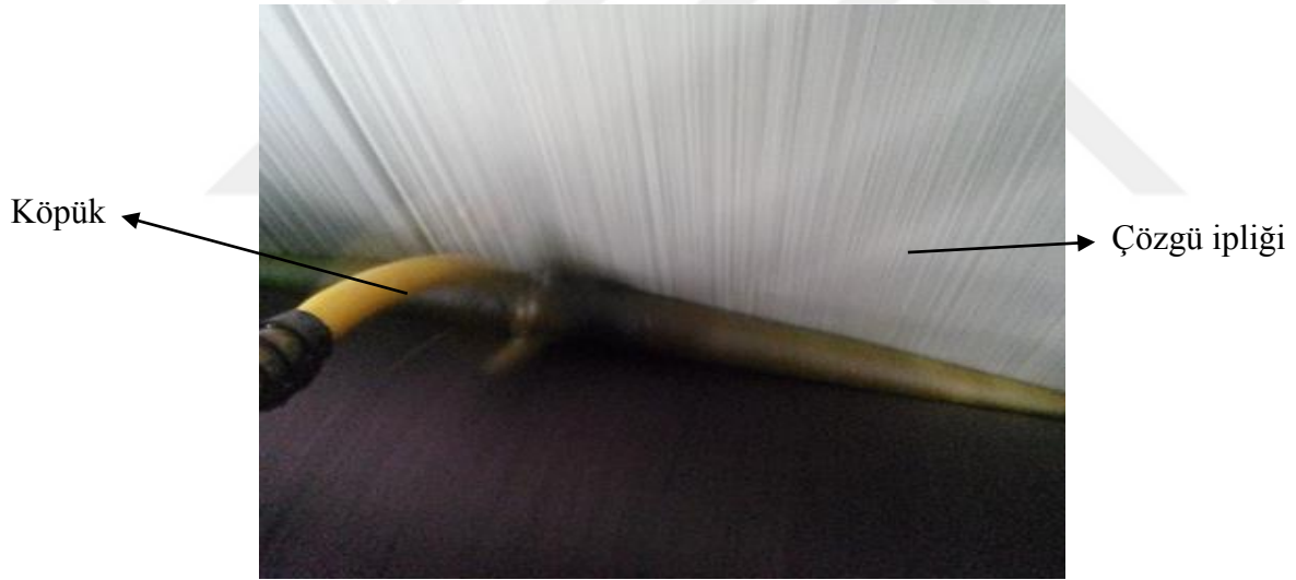
Şekil 5.15. Köpük aparatına beslenen indirgenmiş köpük
