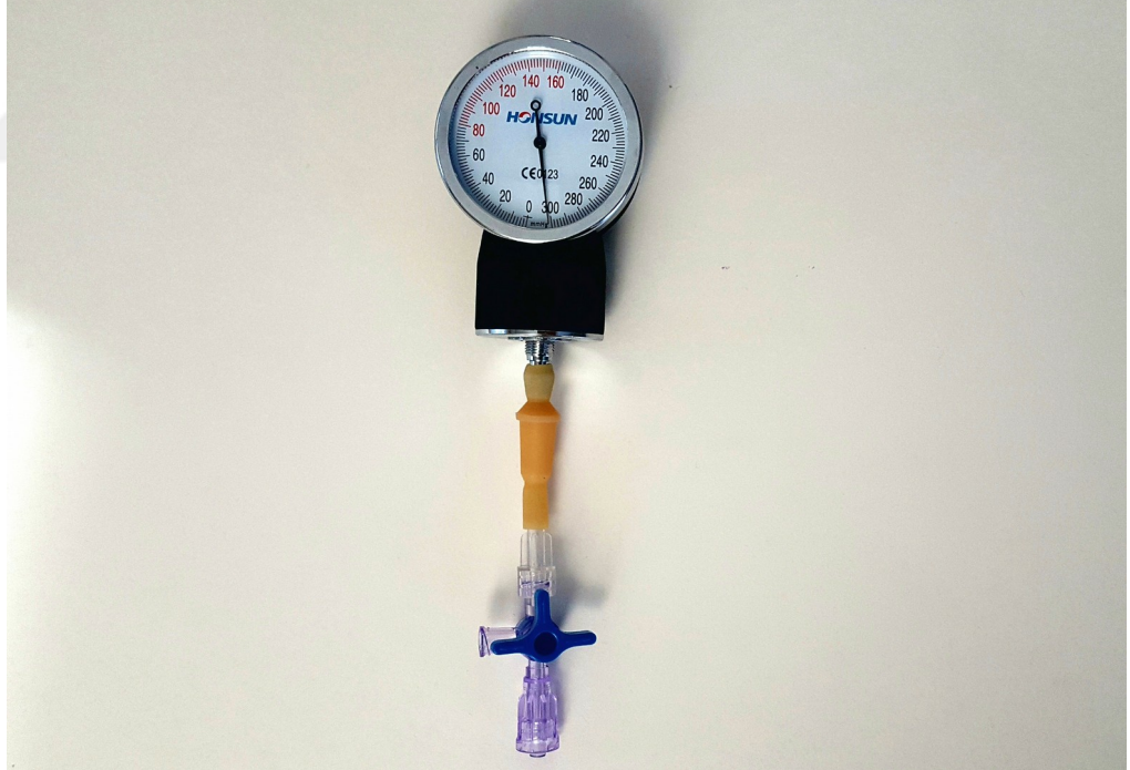
řekil 19: VM'da standardizasyonu saęlamak için kullanılan manometre
