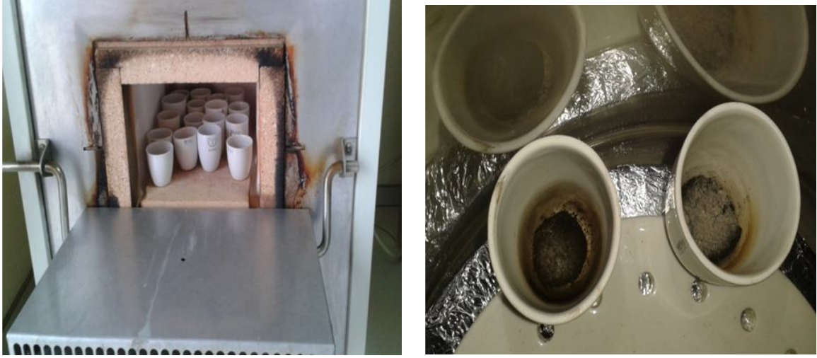
Şekil 3.7. Porselen korozelerde ham kül tayini
