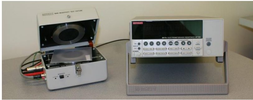
Şekil 1.42. Değişken kutuplama yöntemi ile yüzeyel ve hacimsel iletkenlik ölçümü
