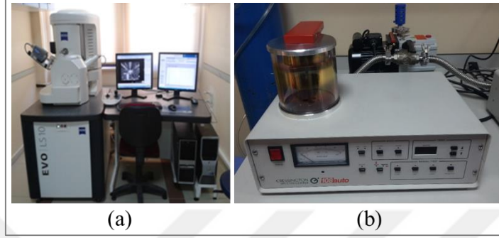
Şekil 3.15. Morfolojik karakterizasyonda kullanılan; a) SEM ve EDX, b) altın kaplama cihazı
