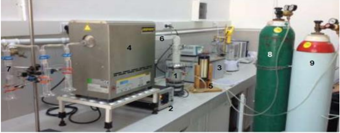
Şekil 3.2. Deney düzeneğinin genel görünümü 1) Atomizör 2) Atomizör güç kaynağı 3) Soğutma sistemi 4) Fırın 5) Akış ölçer 6) Kuvars tüp 7) Toz toplama şişesi 8) Azot gazı 9)Hidrojen gazı.
