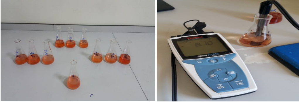
Şekil 3.4. Çilek örneklerinin titrasyona hazırlık aşaması Şekil 3.5. Titrasyon aşaması
