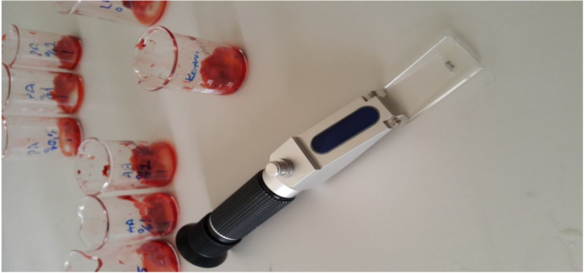
Şekil 3.3. Çilek örneklerinin refraktometre ile ölçümü
