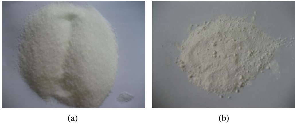
Şekil 3.1 a)Polivinil Alkol (PVA), b)Titanyum dioksit ( TiO_2 )
