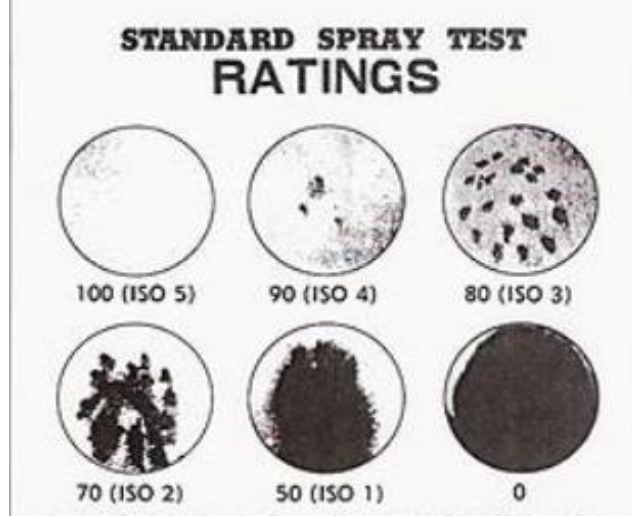
Şekil 7.7. Su iticilik test standardı: 0: Alt ve üst yüzeyin tamamındaki ıslanma, 50 ISO 1: Üst yüzeyin tamamındaki ıslanma, 70 ISO 2: Üst yüzeydeki kısmi ıslanma, 80 ISO 3: Üst yüzeyin spreyn noktalarındaki ıslanma, 90 ISO 4: Üst yüzeyde hafif ıslanma, 100 ISO 5: Üst yüzeyde hiç ıslanmama
