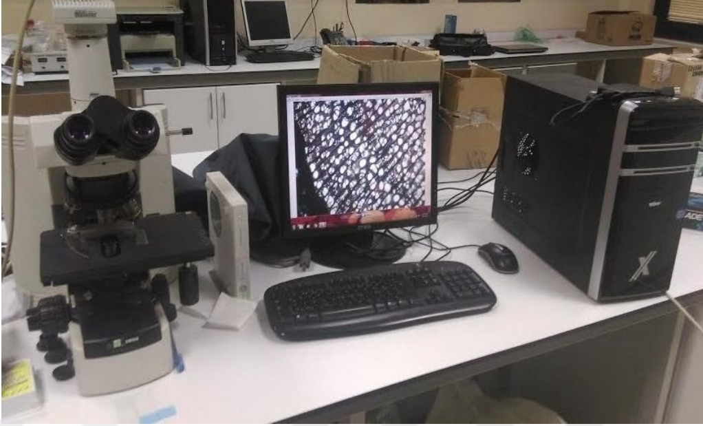
Şekil 3.11. Ölçüm ve görüntülemeye kullanılan kameralı ışık mikroskobu (Nikon Instruments Europe B.V. Amstelveen, Hollanda)
