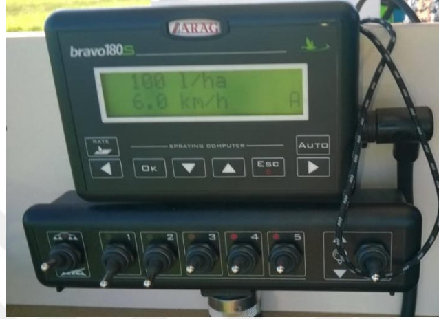
Şekil 3.10. Debi kontrol sistemi bilgisayarı
