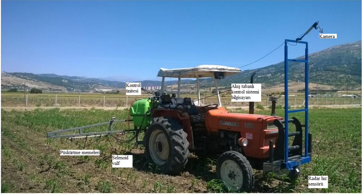
Şekil 3.2. Oluşturulan pülverizatör sisteminin yapısı
