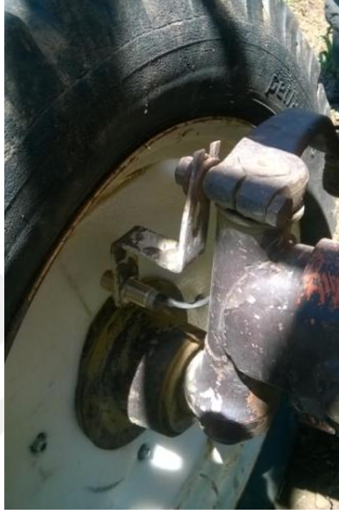
Şekil 3.7. İndüktif sensör ile tekerlekten hız bilgisinin alınması
