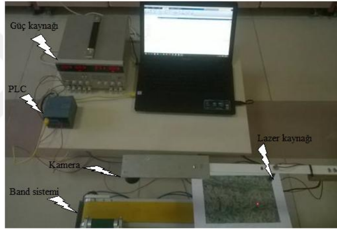
Şekil 3.1. Yerel sensör tabanlı hassas ilaçlama kontrol sistemi
